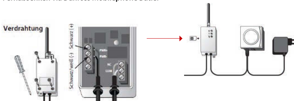
Abb.4 Anschluss des Mobilephone Butler
