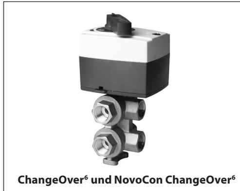
Der ChangeOver<sup>6</sup> und der NovoCon ChangeOver<sup>6</sup> sind motorisierte 6-Wege-Kugelhähne, die eine Umschaltfunktion zwischen zwei Wasserkreisen in 4-Rohr-Systemen realisieren.
