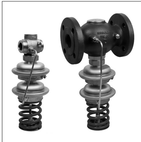
Er ist drucklos geschlossen und öffnet bei steigendem Druck. Der Stellantrieb ist mit zwei Stellmembranen ausgeführt. Bei defekter Regelmembrane wird das Ventil über die Sicherheitsmembrane geöffnet.
