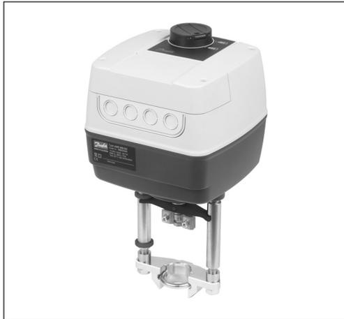
Die Motorstellantriebe der Serien AME 655-1, 658 SU/SD-1 und 685-1 eignen sich für die Ventilsteuerung gemäß den Anforderungen von Fernwärme/-kühlung sowie Heizungs-, Lüftungs- und Klimaanlageanwendungen. Die Stellantriebe der AME658-Serie bieten eine Sicherheitsfunktion beim Öffnen oder Schließen des Ventils bei Stromausfall. Bei den Stellantrieben AME 655-1 und AME 685-1 ist diese Funktion nicht enthalten.
