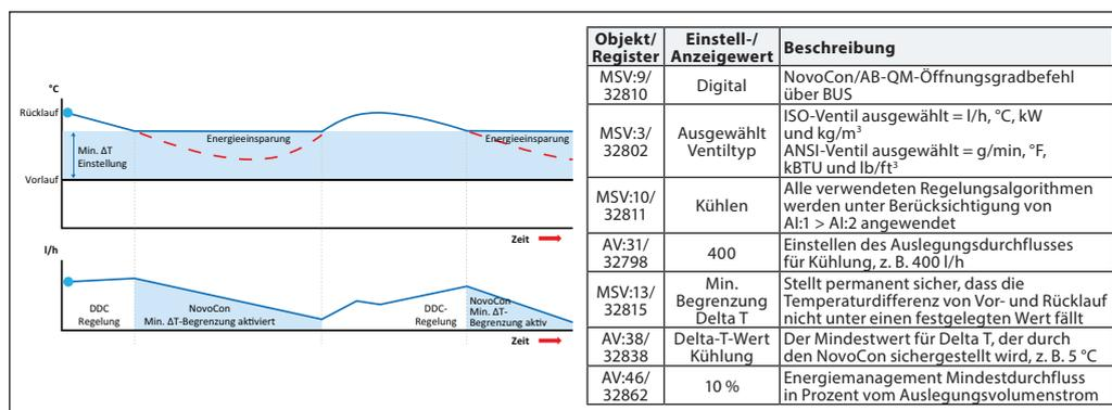
**Zustand 5: Eingestellte Delta-T Regelung (Beispiel Heizwasser)**
