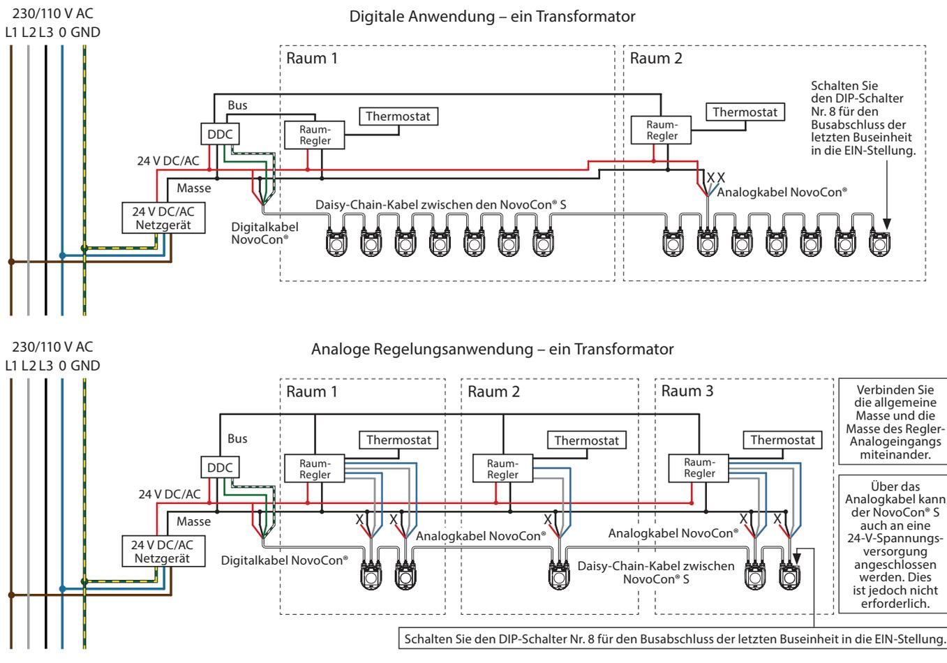
**Verdrahtung mit Wechselspannungsversorgung:**
