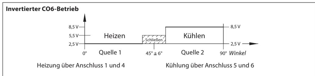
Signal vom NovoCon® S zum Stellantrieb NovoCon® ChangeOver<sup>6</sup>
