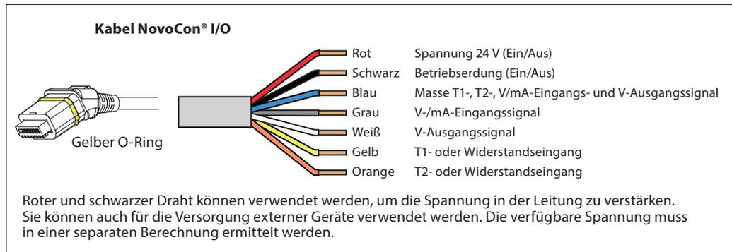
Um elektrische Kurzschlüsse zu vermeiden, muss sichergestellt werden, dass lose Kabelenden **angeschlossen oder isoliert** wurden, bevor der Steckverbinder in den Stellantrieb NovoCon® S eingeführt wird.
