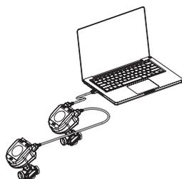
Wenn die Modbus-Funktion 21 (0x15) zum Aktualisieren der Firmware im NovoCon® verwendet wird, ist es notwendig, das Upload in kleinere Abschnitte zu unterteilen, da im Modbus nur Dateien bis zu einer bestimmten Größe verarbeitet werden können. Weitere Details sind dem Modbus-Standard zu entnehmen.
