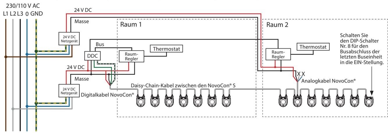
**Verdrahtung mit Gleich- oder Wechselspannungsversorgung:**
