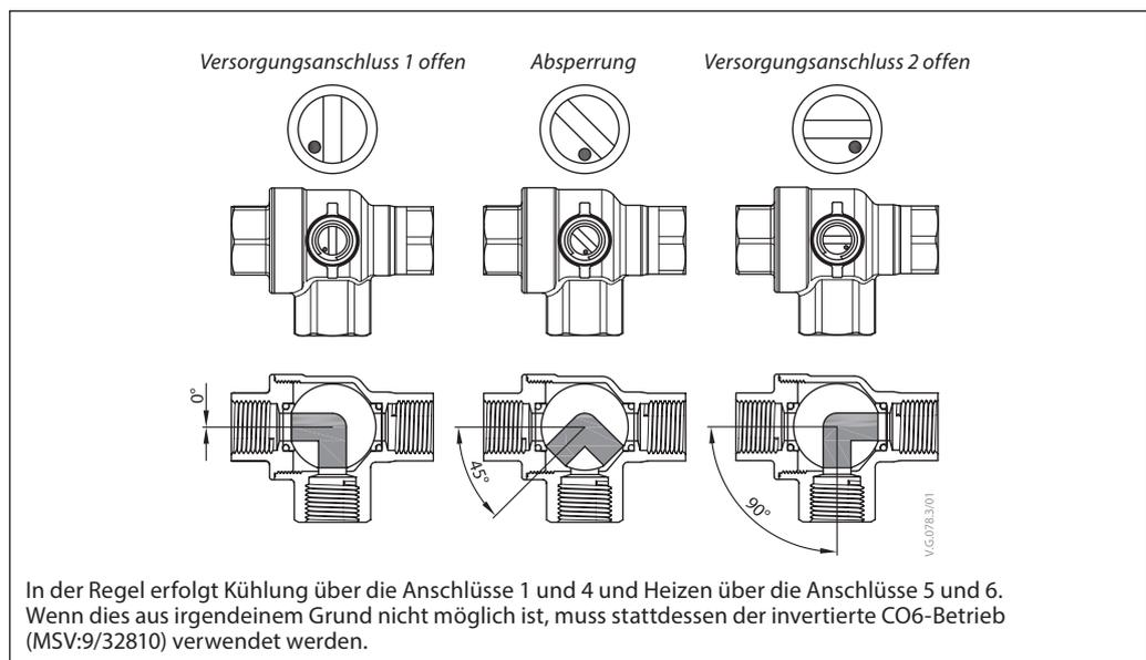
Das CO6-Ventil verfügt im Gegensatz zu anderen Kugelhähnen über eine Absperrfunktion. Diese sollte nur bei Wartungsarbeiten und nicht im Betrieb eingesetzt werden. Durch diese Funktion sind keine zusätzlichen vier Kugelhähne erforderlich. Der Absperrbefehl kann nur ausgeführt werden, wenn der Volumenstrom-Sollwert (AV:1/33280) = 0 ist.
