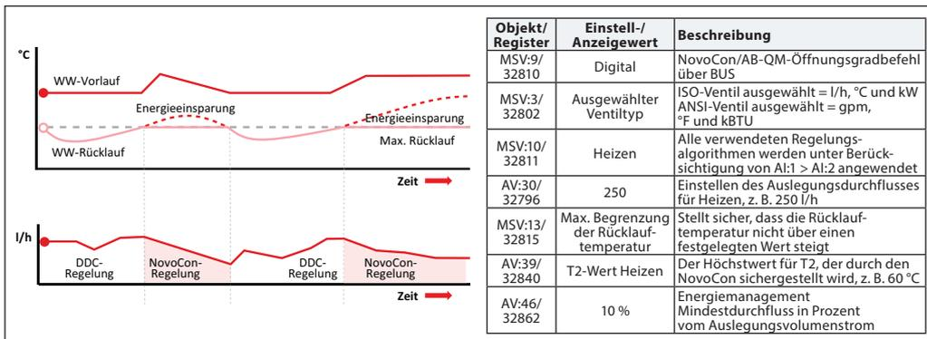
**Zustand 7: Eingestellte Rücklauftemperatur-Regelung (Beispiel Heizwasser)**
