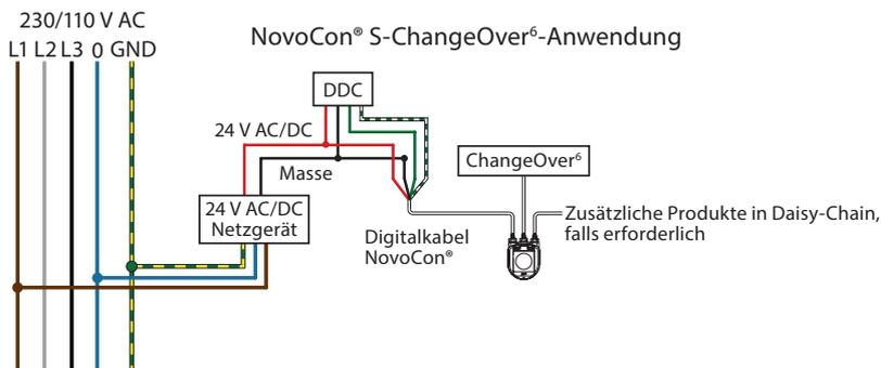
**Verdrahtung analoger CO6-Betrieb**
