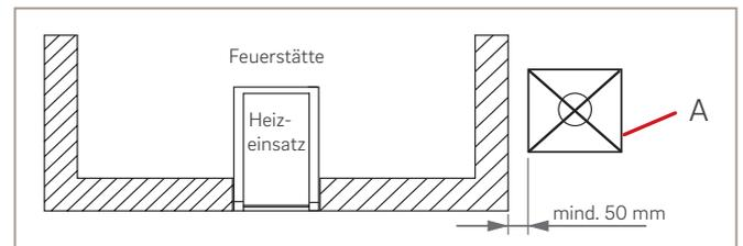
Abb. 5: Schutz und Abstände bei beheizten Flächen, Schema
