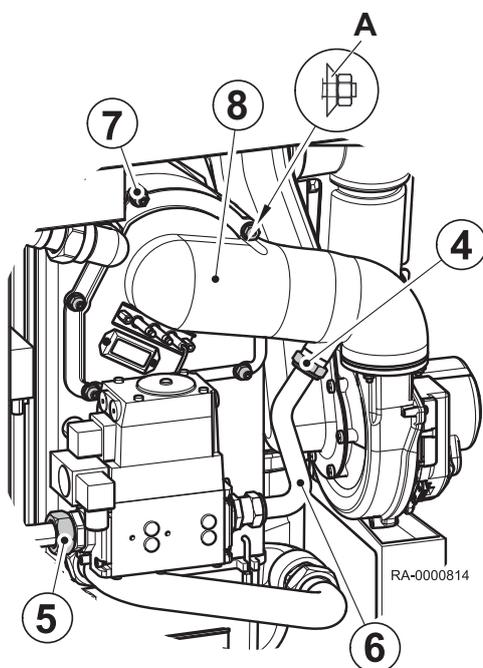
1. Die elektrische Anschlussleitungen zum Gebläse an der Steckvorrichtung abziehen.
