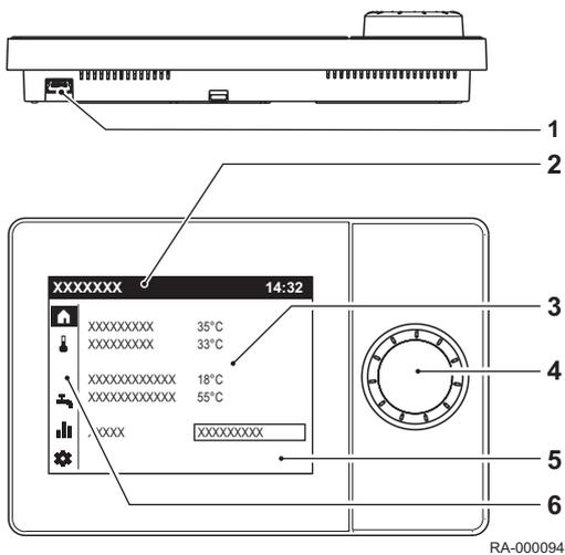
Das Raumgerät wird mit dem Bedienknopf bedient.
