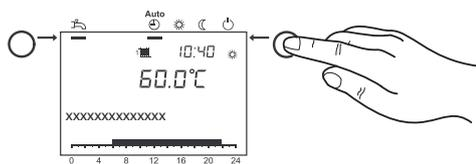
8. Durch Drücken der **Betriebsarttaste Heizbetrieb** die Programmierung verlassen.
