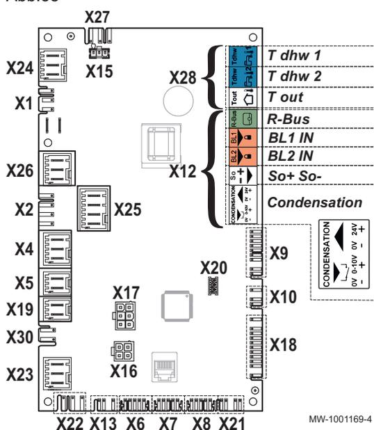
1. Die Optionen je nach Anlagenkonfiguration an den Steckverbinder **X12**, **X19** oder **X30** auf der Regelungsleiterplatte **EHC-04** im Innenmodul anschließen.
