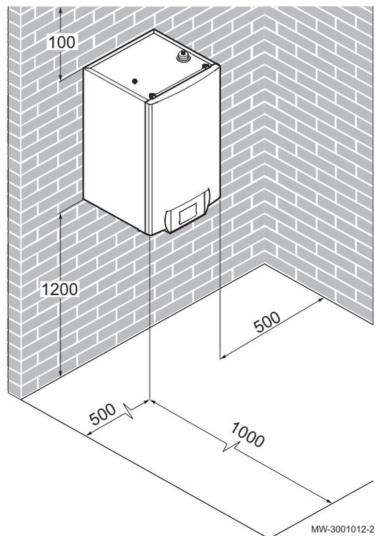
Um das Innenmodul der Wärmepumpe herum muss genügend Platz vorhanden sein, so dass ein guter Zugang zum Gerät gewährleistet ist und die Wartung erleichtert wird.
