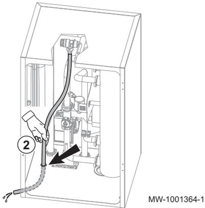
2. Die Abflussleitung des Sicherheitsventils durch die dafür vorgesehene Öffnung stecken.
