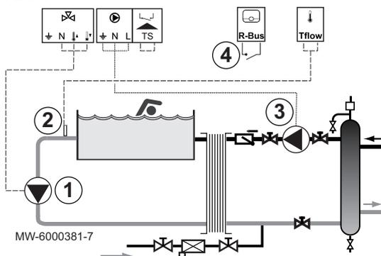
1. Die Sekundärpumpe des Schwimmbads an die Klemmleiste anschließen.
