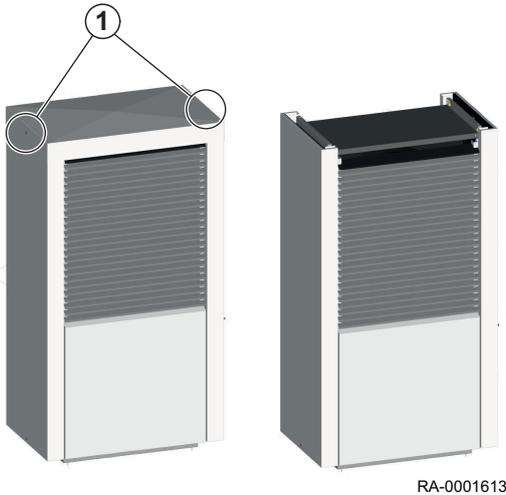
1. Zuerst wird der obere Deckel abgenommen. Dafür müssen an den Seiten die zwei oberen Schrauben gelöst werden.
