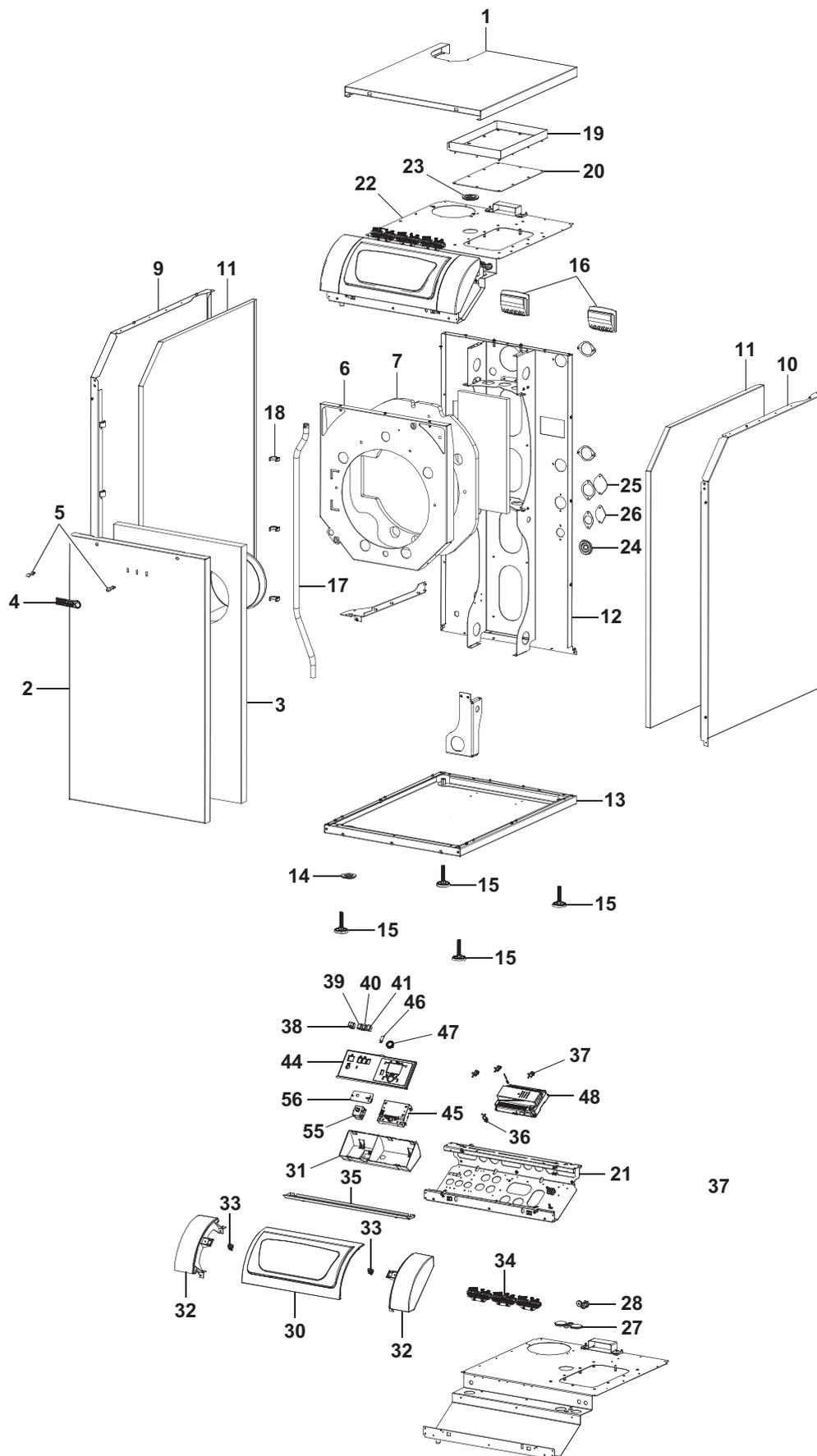
Abb.2 Kessel- und Verrohrungsbauteile
