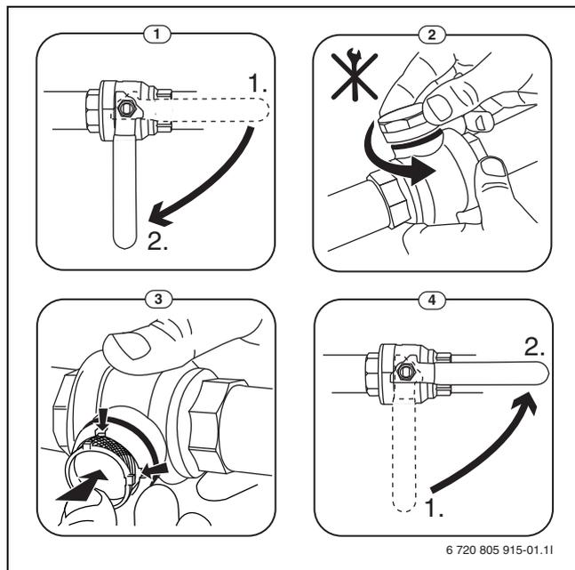
Bild 8 Siebreinigung
