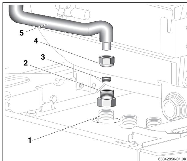
Abb. 1 Klemmringverschraubung montieren
