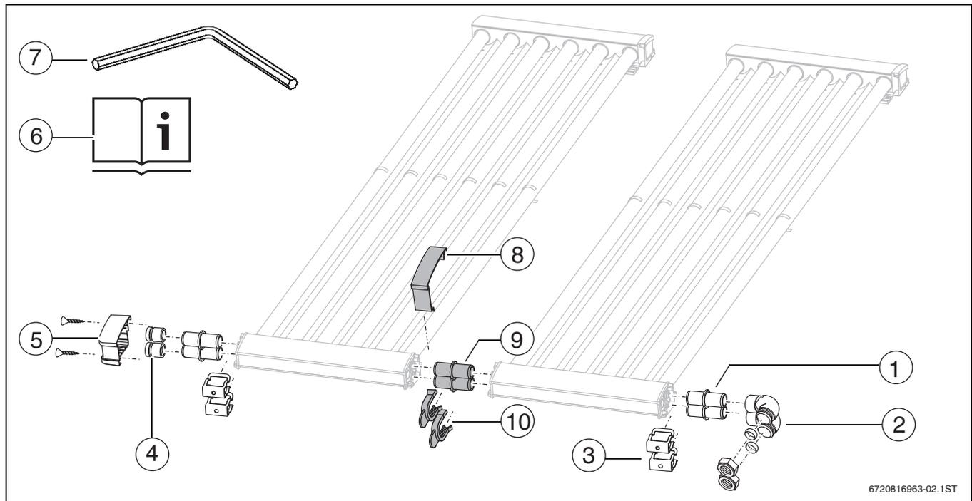
Bild 4 1 Anschluss-Set Flachdach und 2 Verbindungs-Sets (grau)
