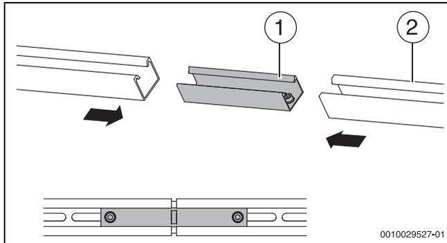
Bild 40 Profilschienen verbinden
