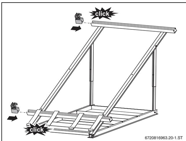
Bild 44 Kollektorspanner montieren
