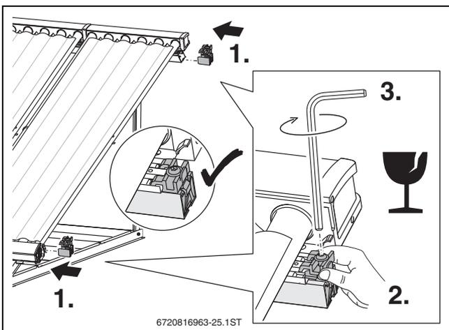
Bild 53 Kollektorspanner montieren
