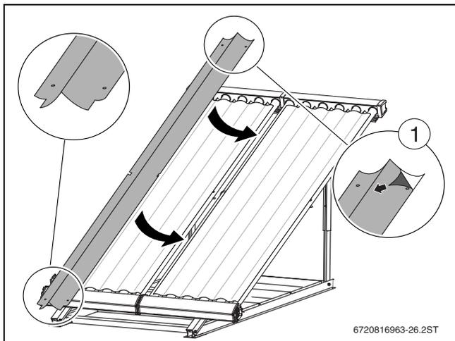
Bild 57 Zwischenspiegel einlegen
