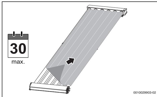
Bild 60 Kollektorfolie entfernen
