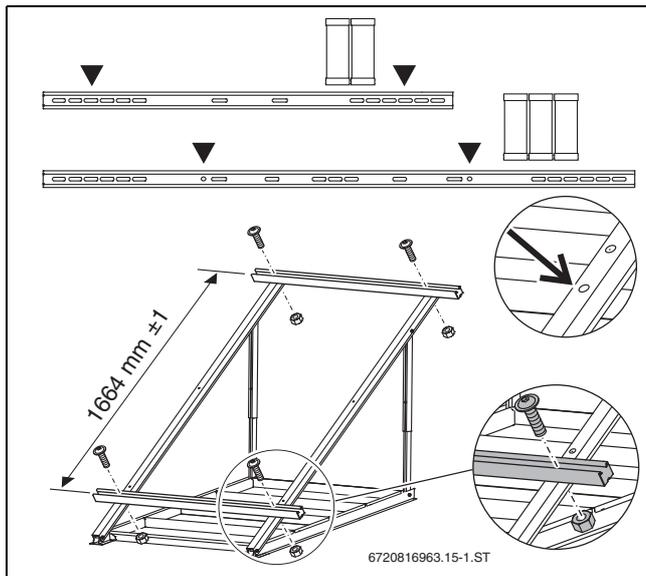
Bild 41 Profilschienen für 2 und 3 Kollektoren montieren
