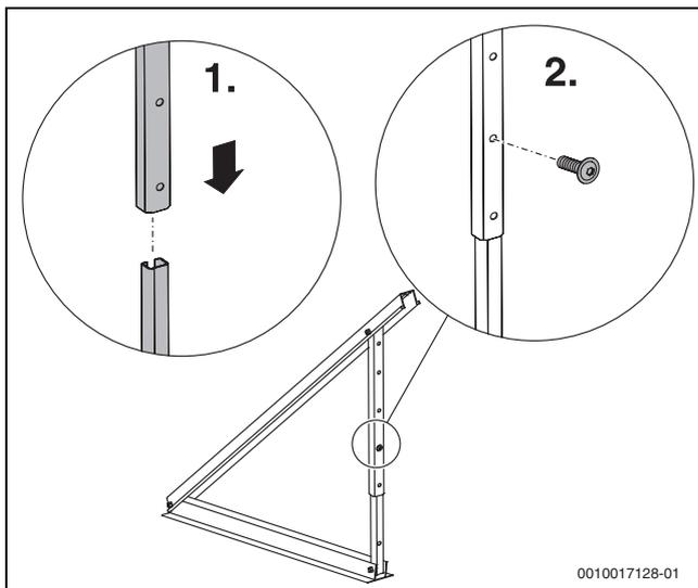
Bild 26 Teleskopschienen montieren
