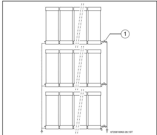
**Bild 16** Maximal 14 Kollektoren je Reihe (Parallelschaltung)
