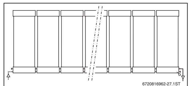
Bild 12 Maximal 14 Kollektoren, wechselseitiger Anschluss (1 Reihe)
