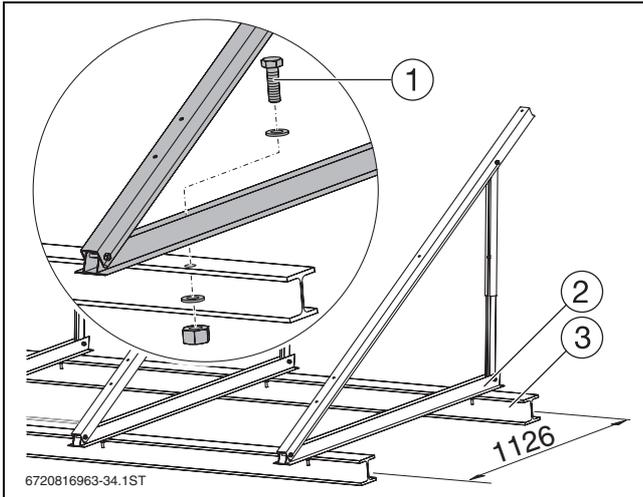
Bild 32 Kollektorstützen auf Doppel-T-Träger, Maße in mm
