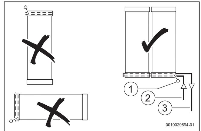
Bild 10 Zulässige Anordnung und Ausrichtung
