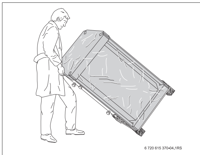
Fig. 4 Colocar el acumulador de agua caliente
