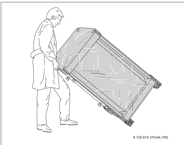
Sl.4 Postavljanje spremnika tople vode
