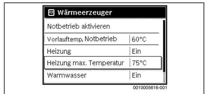
Bild 45 Maximale Vorlauftemperatur
