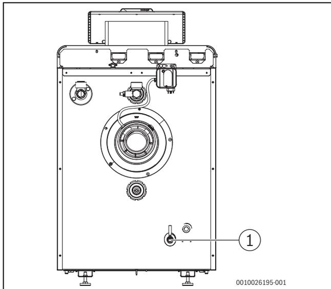
Bild 14 Kondensatschlauch montieren
