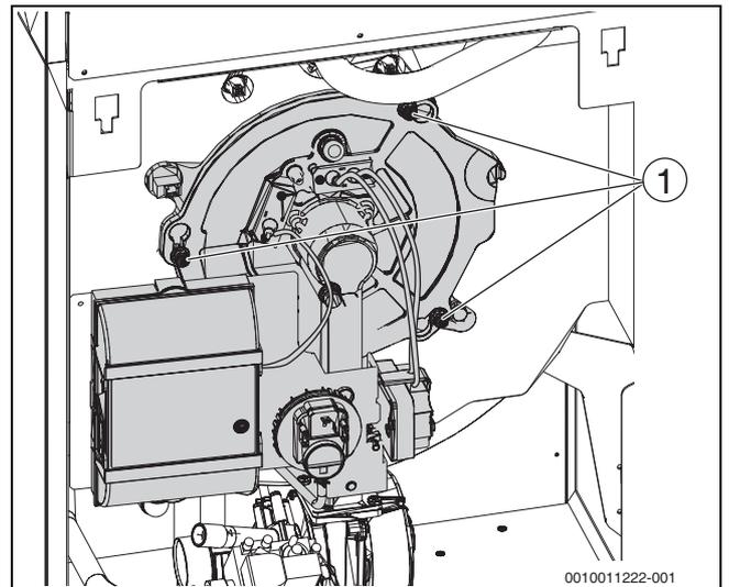
Bild 68 Befestigungsmutter lösen
