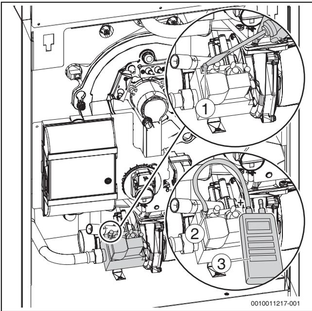
Bild 61 Gas-Anschlussdruck messen
