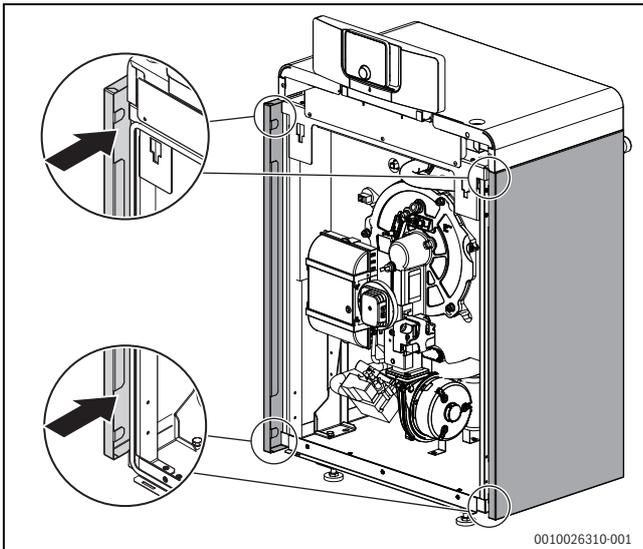
Bild 80 Seitenwände ansetzen und nach hinten schieben
