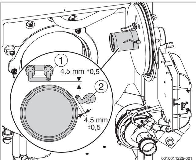
Bild 74 Abstände Elektroden
