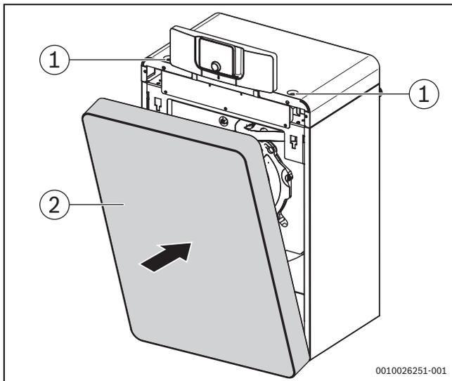
Bild 59 Kesselvorderwand montieren
