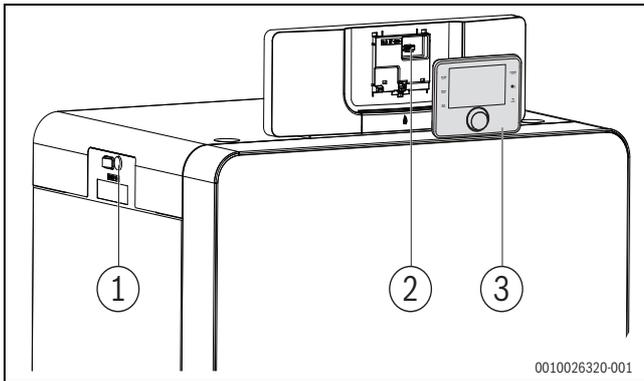
Bild 91 Gerätesicherung
