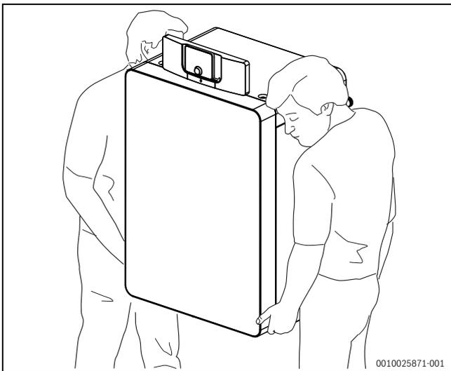
Bild 7 Heizkessel tragen
