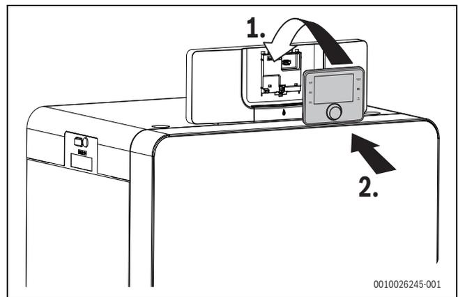
Bild 38 Bedieneinheit einhängen
