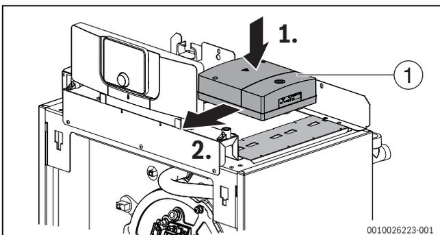
Bild 27 Funktionsmodule einstecken
