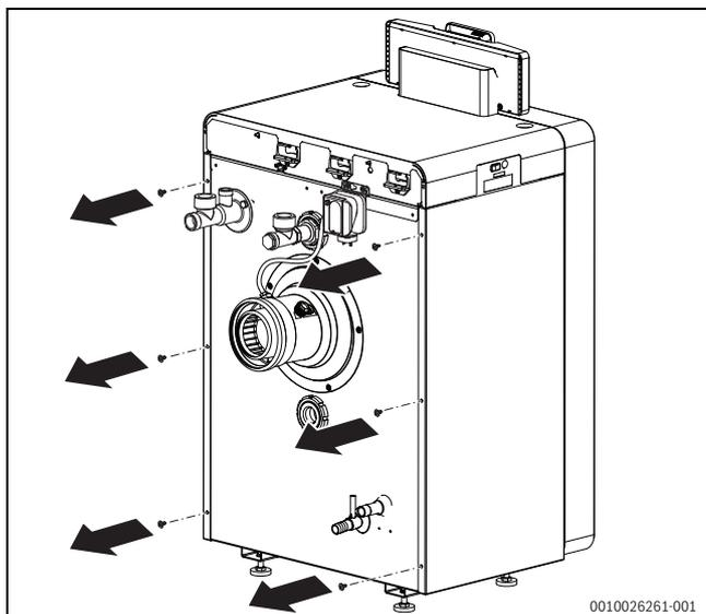
Bild 76 Befestigungsschrauben lösen
