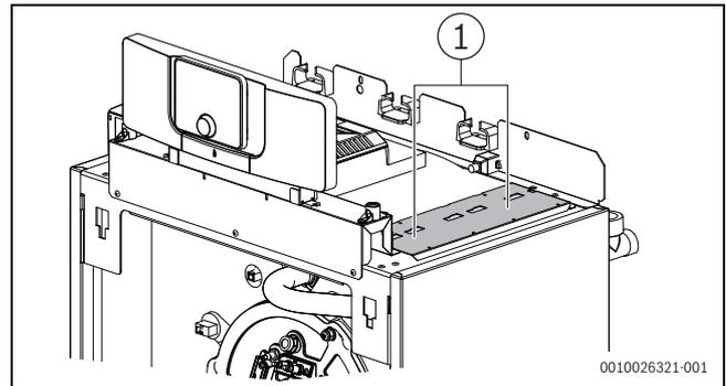
Bild 92 Steckplatz für Funktionsmodule
