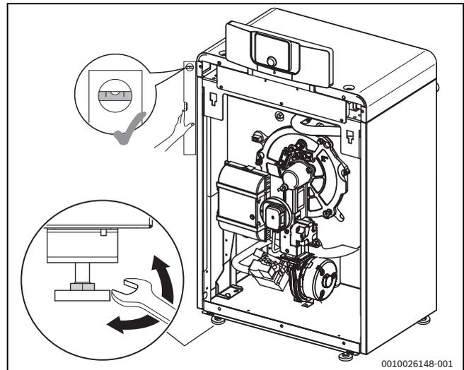
Bild 10 Heizkessel ausrichten
