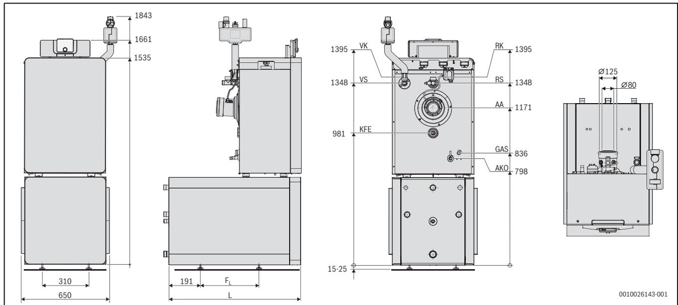
Bild 4 Abmessungen und Anschlüsse GC8000iF mit und WH ...-3 P 2 B (Maße in mm)
