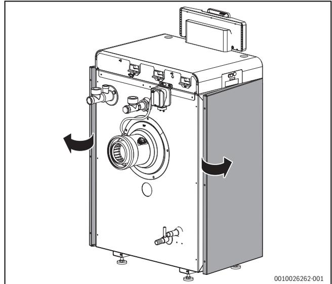
Bild 77 Seitenwände nach außen schwenken
