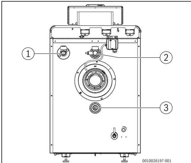
Bild 16 Vorlauf (VK) und Rücklauf (RK) montieren
