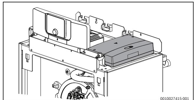
Bild 29 Großes Funktionsmodul montiert
