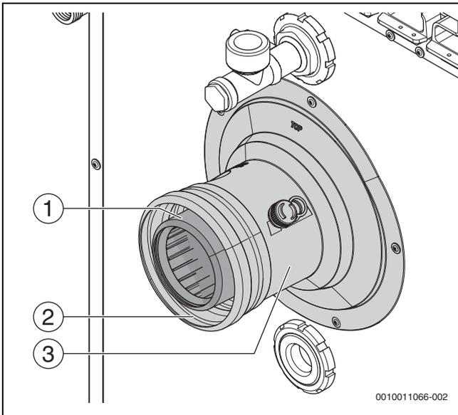
**Bild 11** Abgasanschluss montieren
