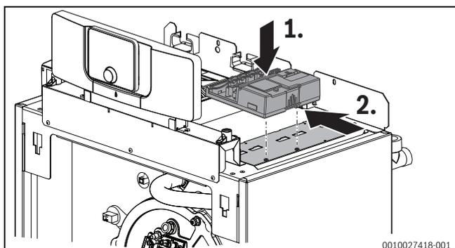
Bild 33 Funktionsmodul aufsetzen
