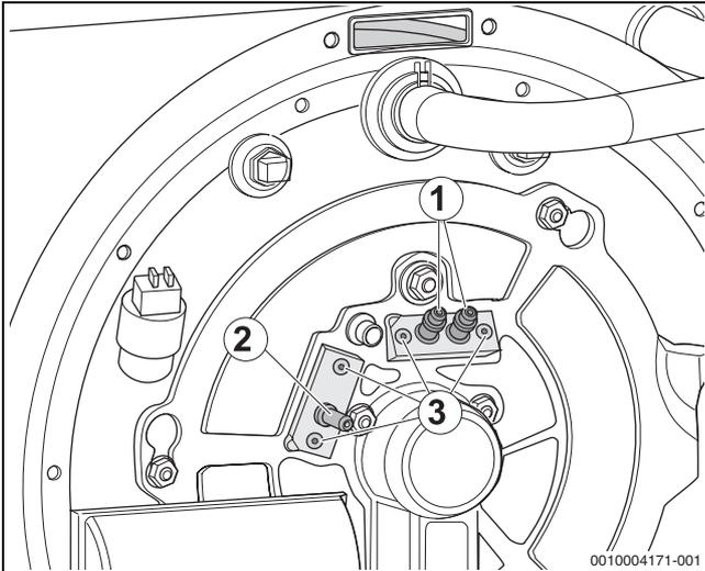
Bild 73 Elektrodenposition
