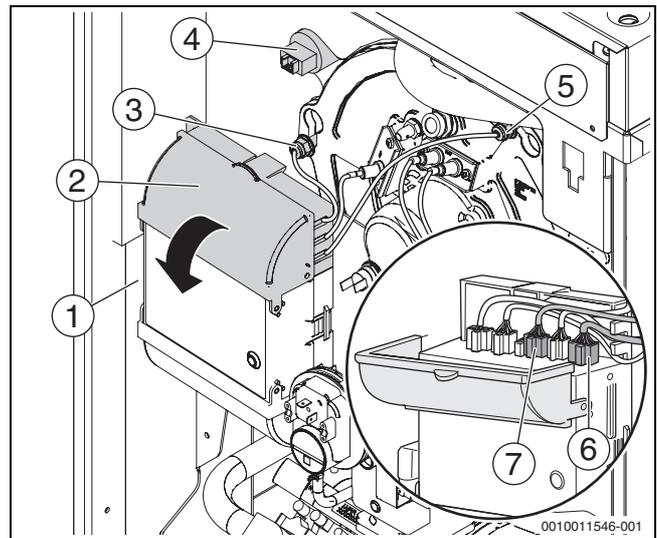
Bild 64 Steckverbinder lösen
