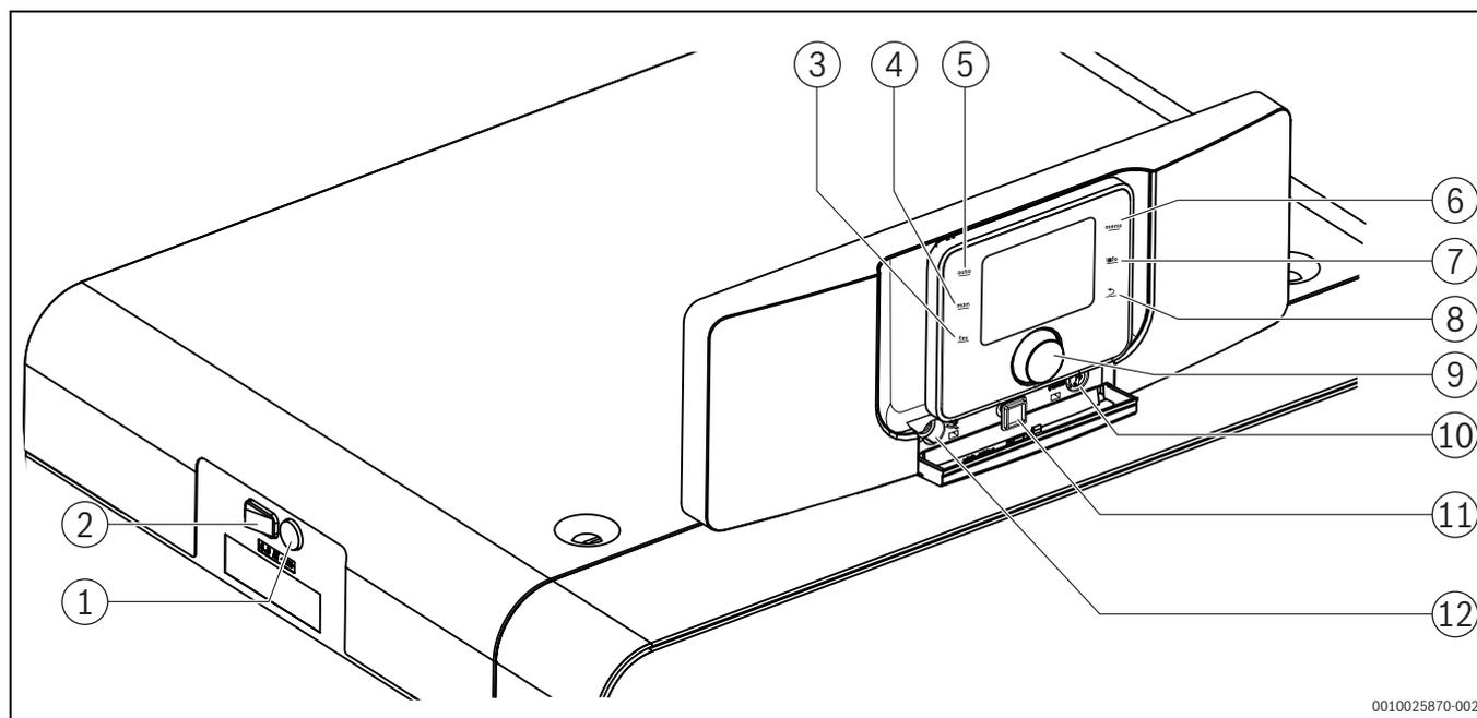
Bild 2 Bedieneinheit (Basiscontroller mit CW 400) – Bedienelemente
