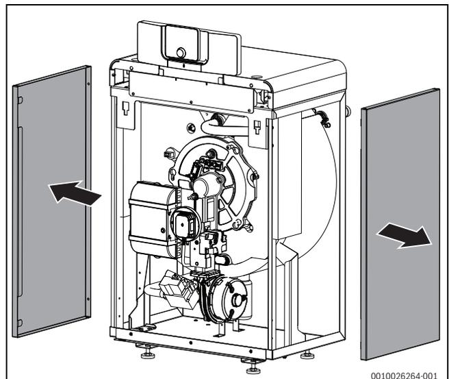
Bild 79 Seitenwände abnehmen
