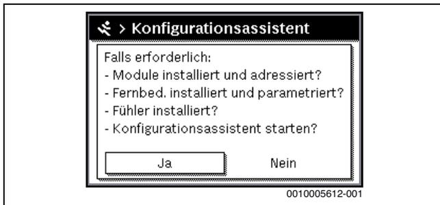
Bild 42 Konfigurationsassistent starten
