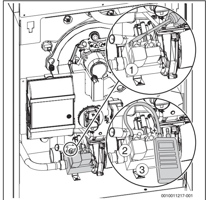
Bild 53 Gas-Anschlussdruck messen
