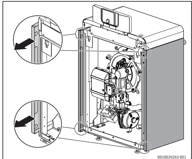
Bild 78 Seitenwände aus dem Rahmen schieben
