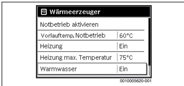
Bild 47 Warmwasserbereitung einschalten
