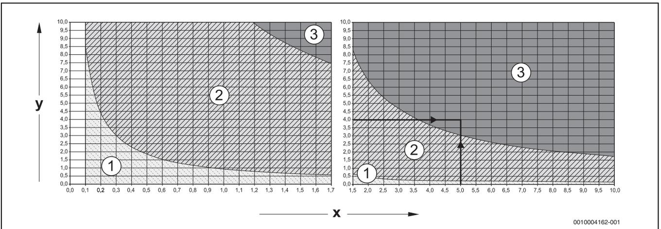
Bild 62 Zulässiger Druckverlust pro Minute bei der inneren Dichtheitsprüfung mit vorhandenem Gasdruck
