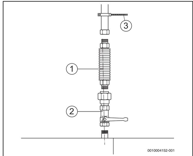
Bild 18 Gasanschluss herstellen
