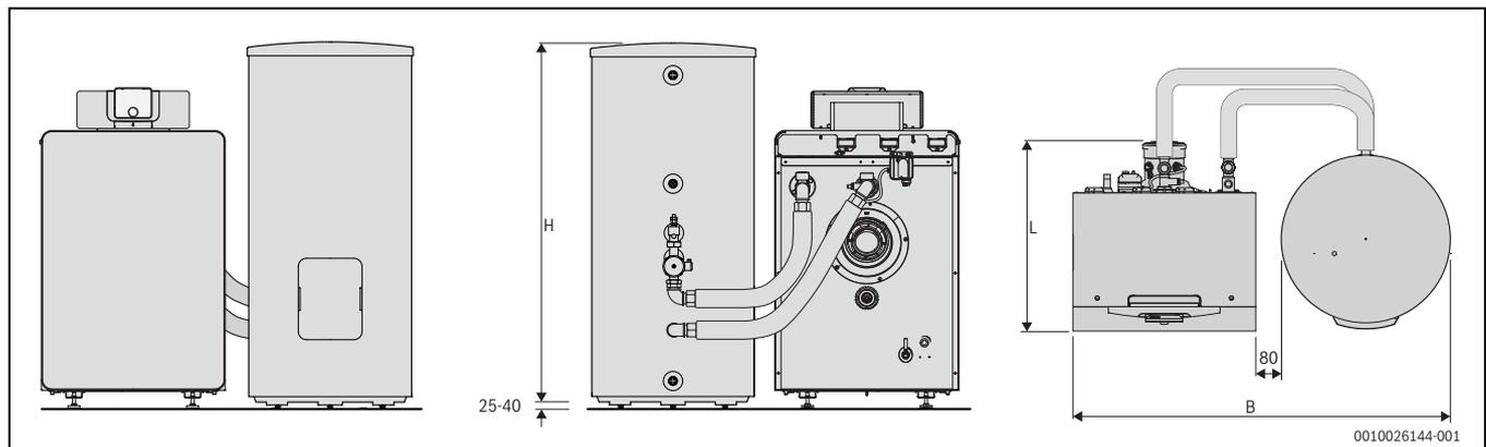
Bild 5 Abmessungen und Anschlüsse GC8000iF mit und W ...-5 P 1 A (Maße in mm)
