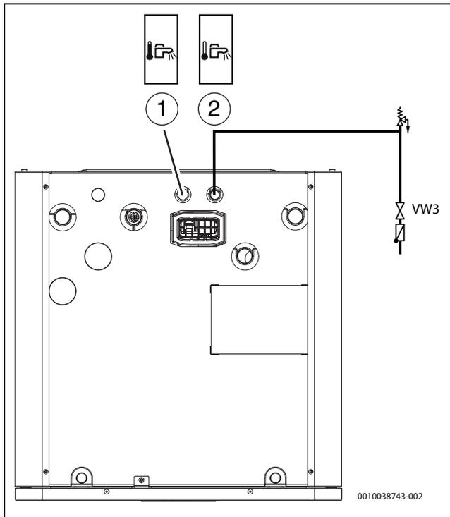
Bild 23 Wärmepumpenanschlüsse Trinkwasser
