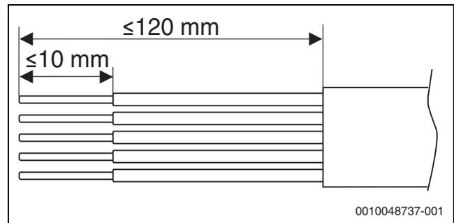
Bild 29 Abisolieren der Adern für den Netzanschluss
