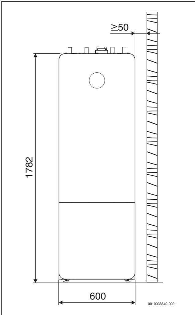
Bild 3 Abmessungen (mm)
