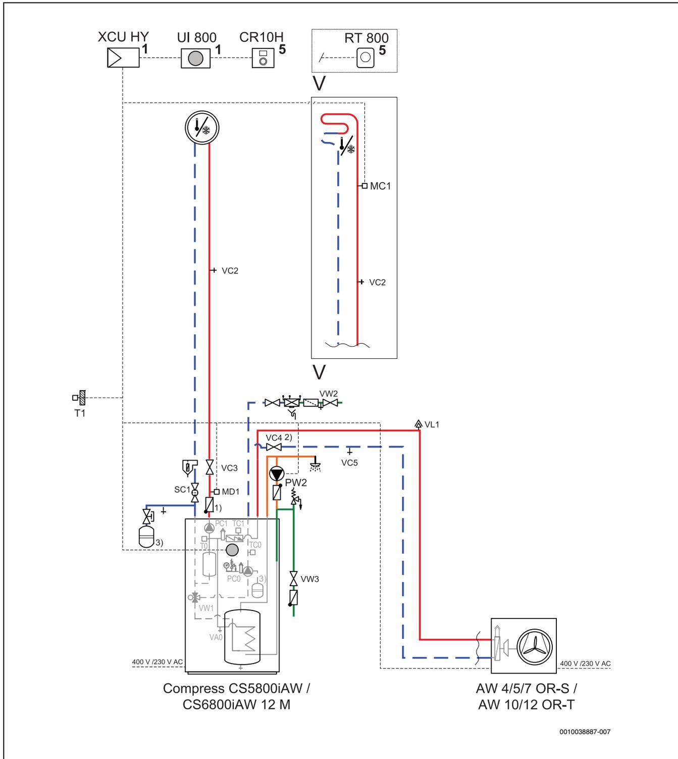
Bild 46 Tower Inneneinheit, Wärmepumpe (ODU), ein ungemischter Heizkreis
