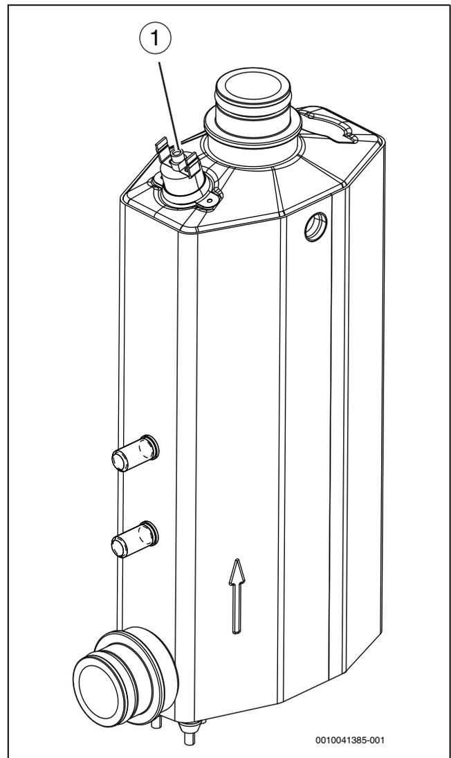
Bild 42 Elektrischer Zuheizer
