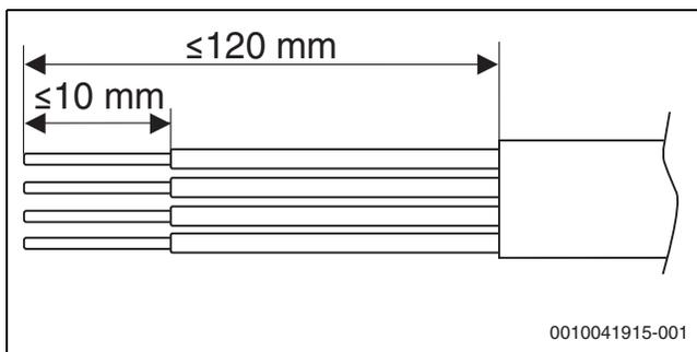
Bild 26 Abisolierung CAN-BUS
