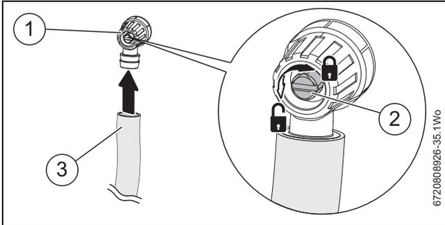
Bild 50 Entleerungsanschluss
