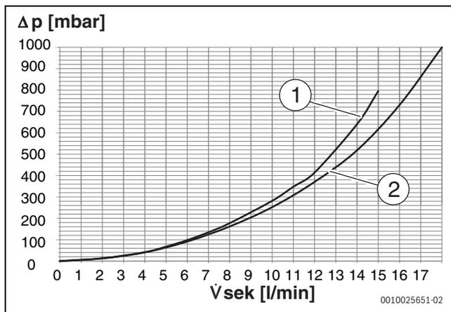
Bild 6 Druckverlust Trinkwasserseite
