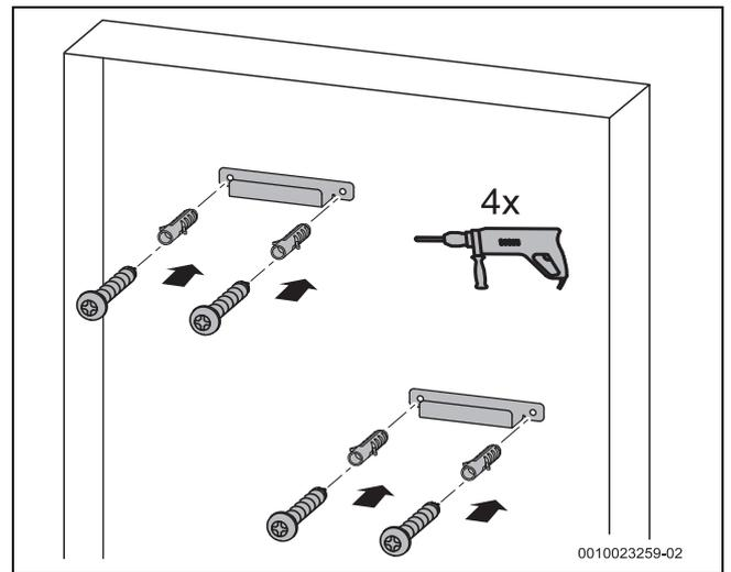
Bild 25 Beiliegende Wandhalter und montieren
