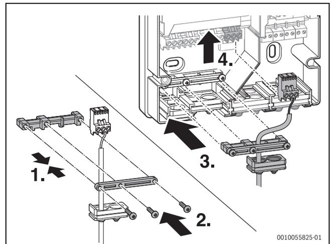
Bild 38 Zugentlastungen montieren und Stecker einstecken
