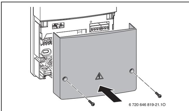
Bild 40 Abdeckung montieren
