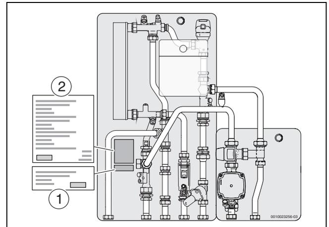
Bild 4 Typschild und Datenschild
