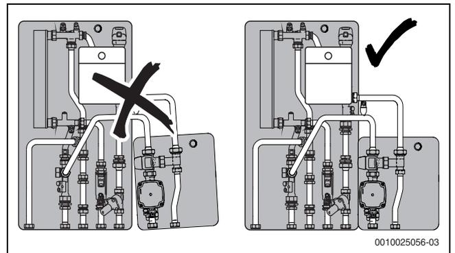
Bild 31 Module müssen gerade hängen
