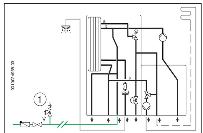
Bild 20 Sicherheitsventil im zentralen Kaltwassereintritt montieren
