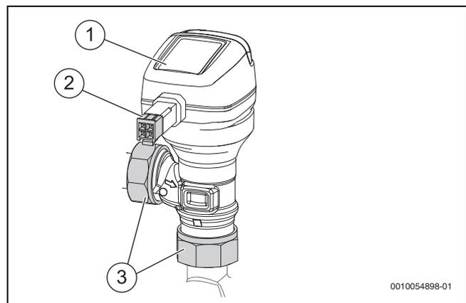
Bild 56 Regelventil
