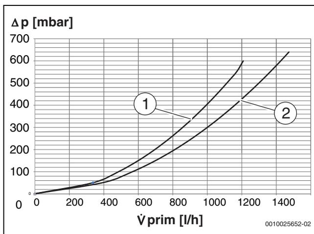
Bild 7 Druckverlust Primärseite
