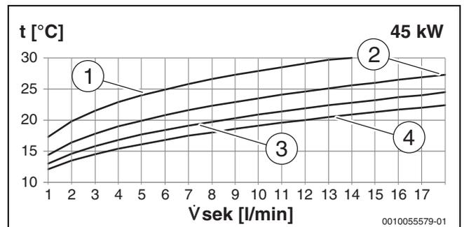
Bild 13 45 kW - Rücklauftemperatur bei Wassererwärmung von 10 auf 45 °C
