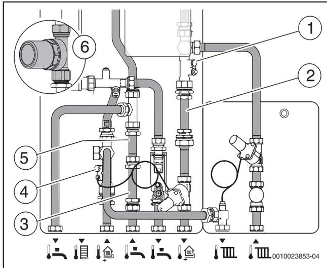
Bild 32 Adapterrohre ersetzen
