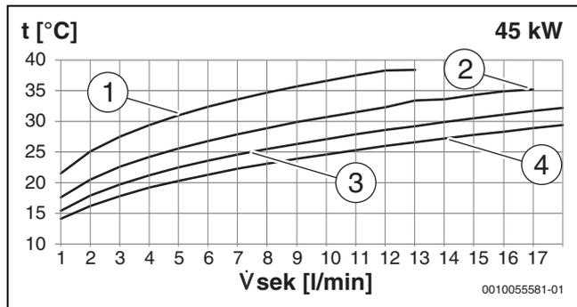
Bild 15 45 kW - Rücklauftemperatur bei Wassererwärmung von 10 auf 60 °C
