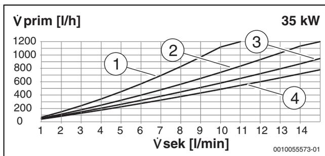
Bild 8 35 kW - Schüttleistung bei Wassererwärmung 10 auf 45 °C
