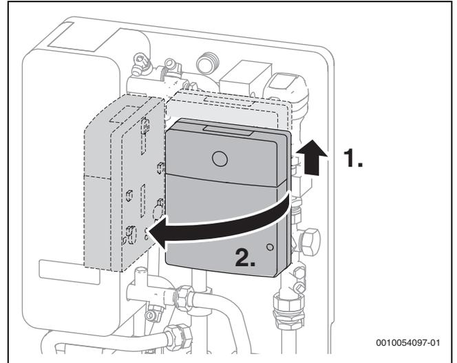
Bild 52 Modul in Wartungsstellung umsetzen
