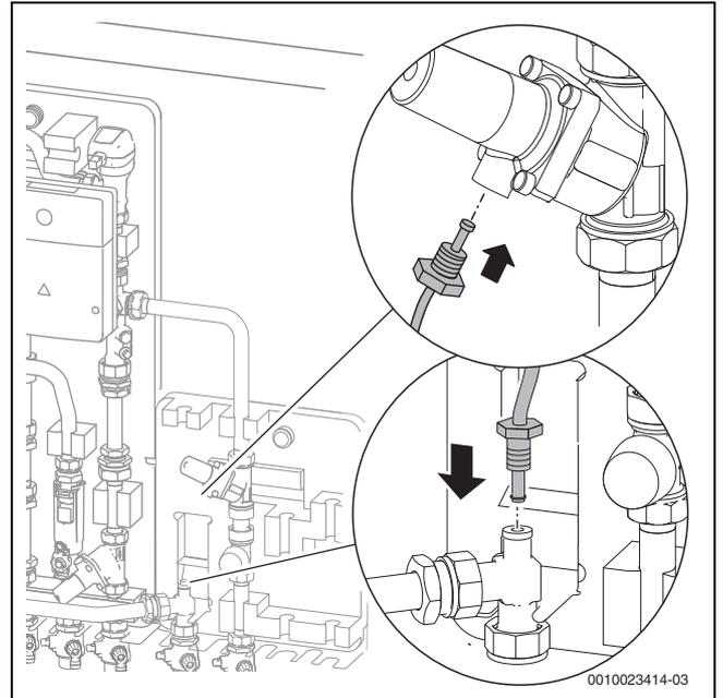
Bild 30 Kapillarleitung montieren
