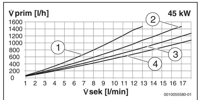
Bild 14 45 kW - Schüttleistung bei Wassererwärmung 10 auf 60 °C
