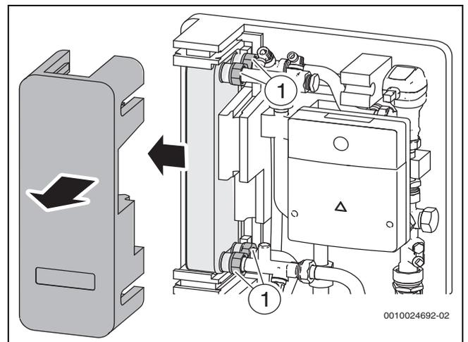
Bild 53 Wärmetauscher demontieren
