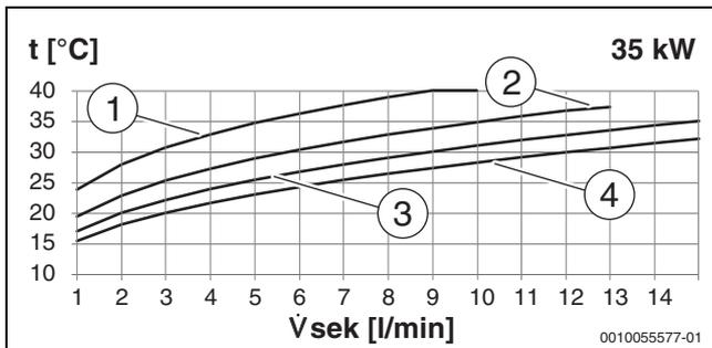
Bild 11 35 kW - Rücklauftemperatur bei Wassererwärmung von 10 auf 60 °C
