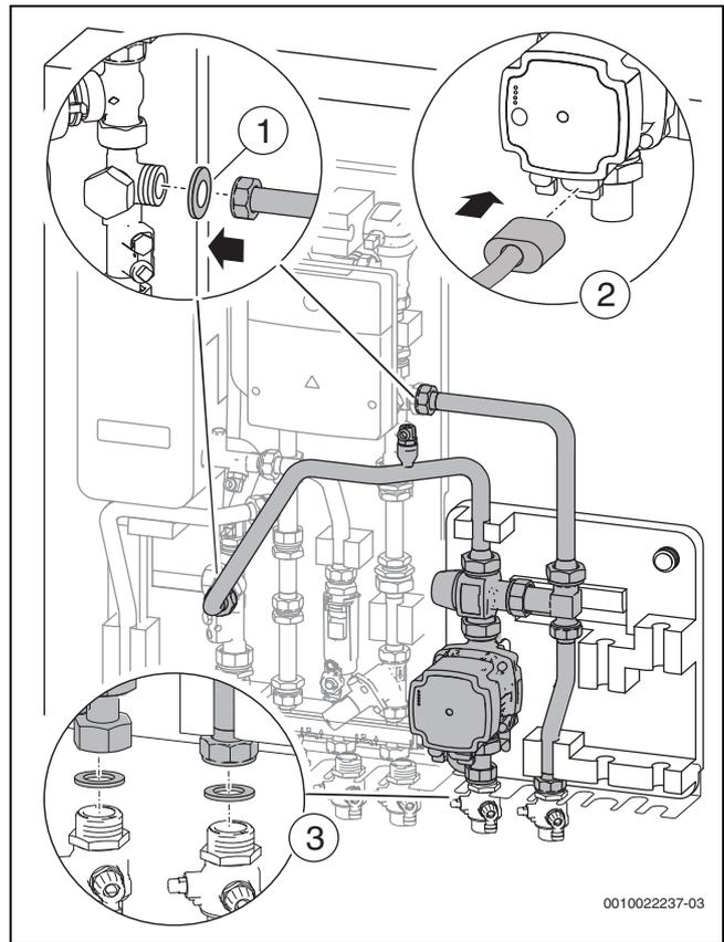
Bild 28 Heizkreismodul montieren
