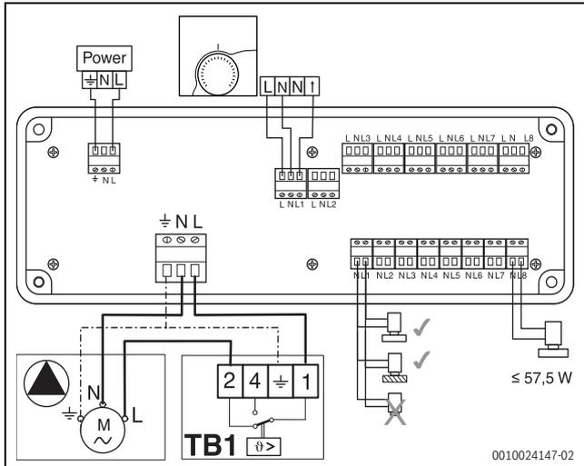
Bild 35 Elektrischer Anschluss an die Klemmleiste Fußbodenheizung (Zubehör)
