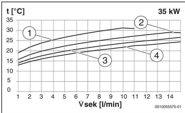
Bild 9 35 kW - Rücklauftemperatur bei Wassererwärmung von 10 auf 45 °C
