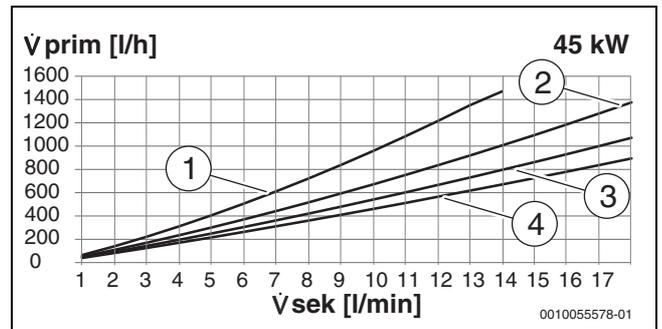
Bild 12 45 kW - Schüttleistung bei Wassererwärmung 10 auf 45 °C
