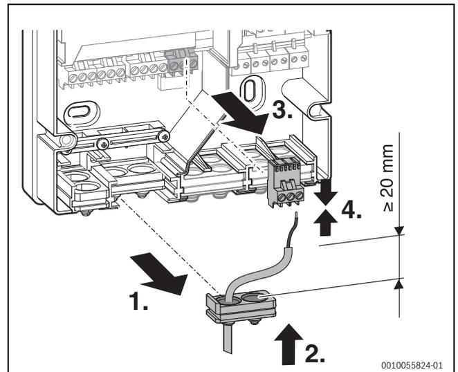
Bild 37 Kabel vom Heizkreisverteiler anschließen
