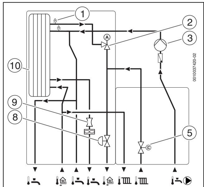
Bild 18 Ungemischter Heizkreis ohne Differenzdruckregler Heizkreis, mit Zirkulationspumpe (Zubehör)
