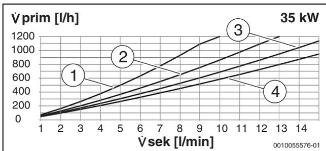
Bild 10 35 kW - Schüttleistung bei Wassererwärmung 10 auf 60 °C
