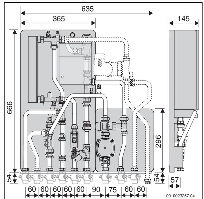
Bild 5 Abmessungen der Station mit Modul gemischter Heizkreis, Zubehör Hochtemperaturabgang und Zirkulationspumpenkit
