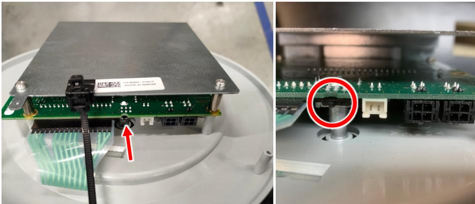
3. Beim Umrüsten des C-Modells von IVT muss auch die Vorderwand ausgetauscht werden. Rego 1000-Display mit 4 Starlock-Befestigern an der beiliegenden Vorderwand anschrauben.
