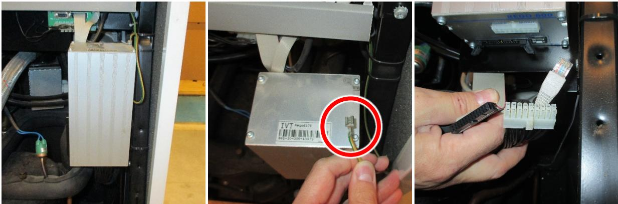
6. Montagehalterung des Rego 63x-Moduls abschrauben. 2 Schrauben.
