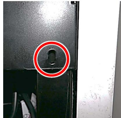
Bei E/LW-Modellen wird der Deckel gegen das Anschlussmodul geerdet. Im Bild ist die Lage der Schraube angegeben, die mit einer Zahnscheibe zu versehen ist. (Das Bild zeigt das Anschlussmodul ohne Deckel vor dem Einbau in die Wärmepumpe.)
