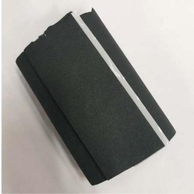
Armaflex-Tape/-Dämmung (zur Dämmung des Vorlauftemperaturfühlers)
