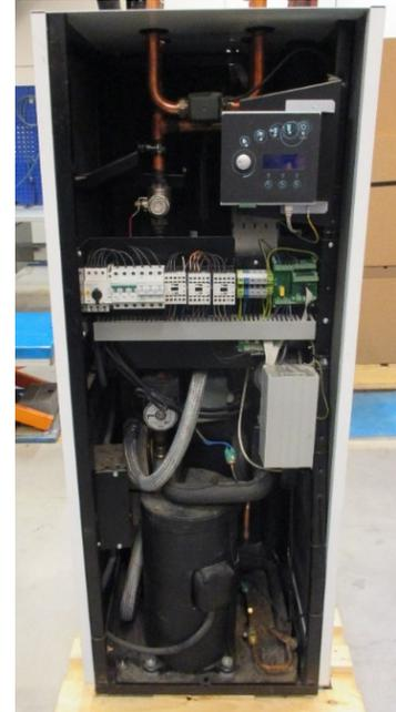
3. Kommunikationskabel und Erdungskabel von der Displayeinheit abklemmen.
