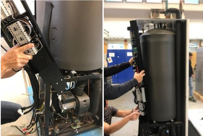
23. Anschlussmodul oben mit 2 M5-Schrauben sowie an der Seite mit 1 M5-Schraube mit Zahnscheibe (gestrichelte Markierung) anschrauben. Die Zahnscheibe ist wichtig, um die ordnungsgemäße Erdung sicherzustellen.
