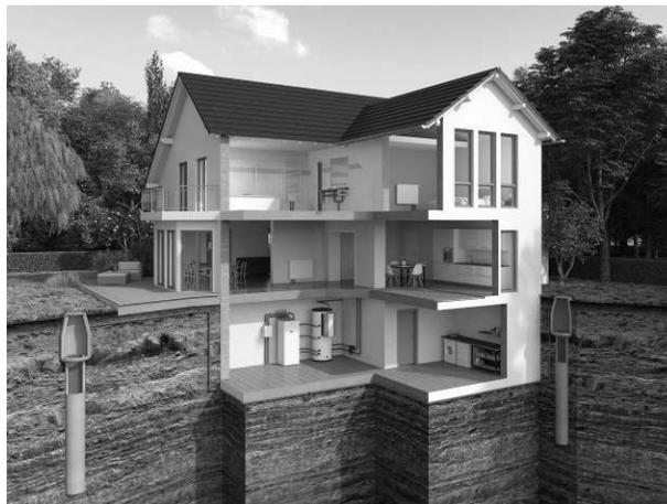
Auch an sehr kalten Wintertagen sinkt die Temperatur von Grundwasser in der Regel nicht unter 7 °C. Über das ganze Jahr hinaus ist die Temperatur des Grundwassers nahezu konstant. Grundwasser wird über einen Saugbrunnen entnommen, über einen Wärmetauscher wird Wärme abgeführt. Anschließend wird das leicht abgekühlte Grundwasser über einen Schluckbrunnen wieder in die Umwelt zurückgeführt.
