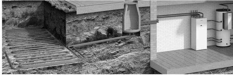
Ähnlich einer Fußbodenheizung werden für Erdwärmekollektoren Rohrschlangen eingesetzt. Die Rohrleitungen sollen ca. 20 cm unterhalb der örtlichen Frostgrenze liegen. In 1,2–1,5 m Tiefe ist das Erdreich ohne Wärmeentzug durch die Wärmepumpe frostsicher. Durch Sonneneinstrahlung und Regen wird dem Erdwärmekollektor Energie zugeführt.
