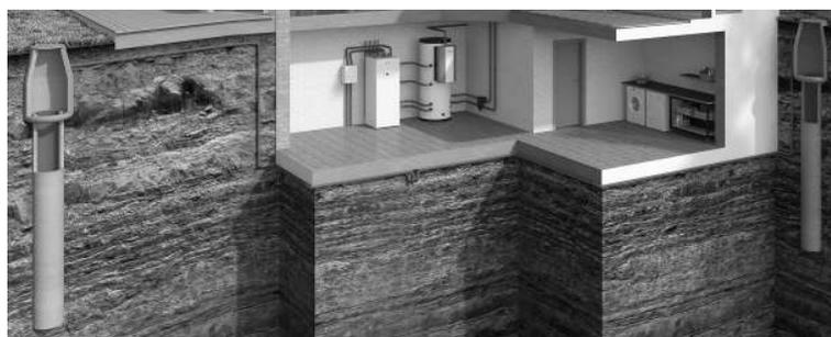
Die Wasser/Wasser-Wärmepumpe wird in der Regel als monovalente Heizung eingesetzt. Durch das hohe Temperaturniveau der Wasserquellen werden hohe Leistungszahlen erreicht. Die Nutzungsart dieser Wärmequelle ist abhängig von der chemischen Zusammensetzung des Grund- bzw. Oberflächengewässers, der Quellentemperatur sowie möglichen behördlichen Vorschriften.
