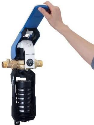
2. Hochziehen des Einhebels auf ca. 130° – Herausziehen des Stützkörpers inkl. Filtertasse und Filterelement.
