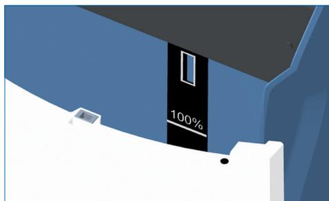
Maximal-Niveau 100 % in der Anzeige des Multi-Info-Touch-Displays entsprechen ca. 46 cm Füllhöhe des Regeneriermittels im Regeneriermittelbehälter.
