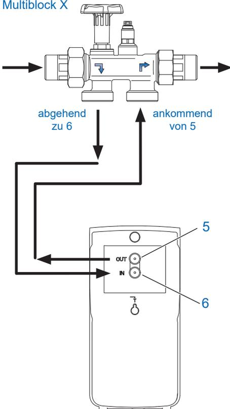
Das Produkt entsprechend nebenstehendem Schema anschliessen. Im Multiblock X ist ein Bypass integriert. Der Einbau ist in waagrecht und senkrecht verlaufende Rohrleitungen möglich.
