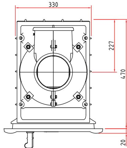
Abgang oben: inkl. Reduzierstück  $\varnothing$  158a auf  $\varnothing$  143a
