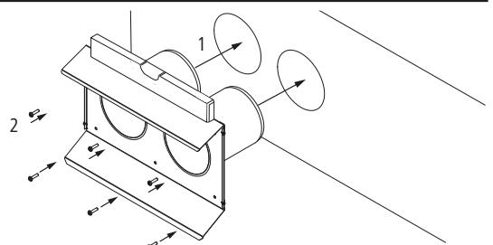
4. Bringen Sie die den Dämmstreifen an dem mittleren Steg auf der Fortluftseite der Abdeckung an.
