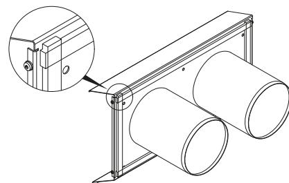
3. Stecken Sie die Grundplatte des Wetterschutzgitters in die Wandöffnung bzw. in die durch die Wand stehenden Luftleitungen. Fixieren Sie die Grundplatte mit einem für den Untergrund geeigneten Befestigungsmaterial an der Außenwand.
