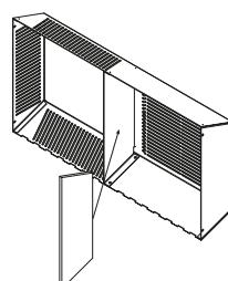
5. Stecken Sie die Abdeckung in der gewünschten Ausführung über die Grundplatte und fixieren Sie diese mit den Blechschauben.
