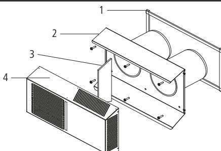
1 Dichtband                    3 Abdeckung
