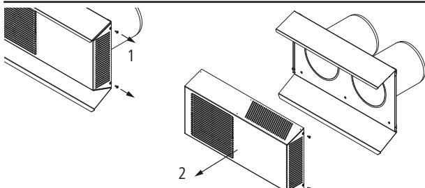
2. Bringen Sie das im Lieferumfang enthaltene Dichtband an der Rückseite der Grundplatte an. **Achtung:** Achten Sie darauf, dass das Dichtband an den Ecken überlappt.
