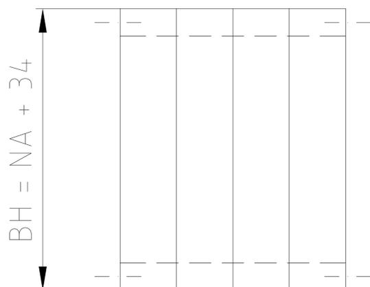
Bei Lage der Anschlüsse seitlich wird immer eine Sonderbauhöhe gefertigt.
