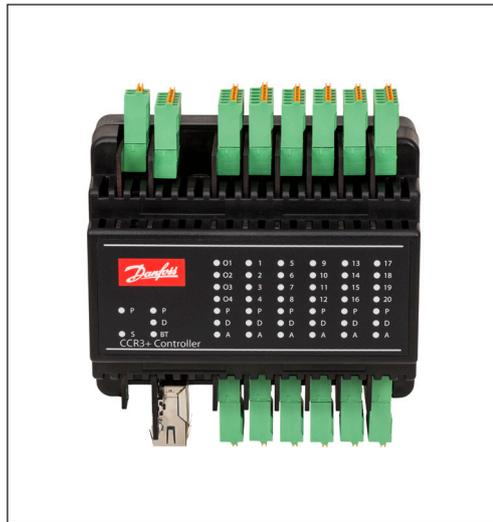
Der elektronische Regler CCR3+ regelt die Rücklauftemperatur in Strängen von Einrohr-Heizsystemen abhängig vom Vorlauftemperatursignal. Mit dem Regler CCR3+ wird das Einrohr-Heizsystem zu einer effizienten Anlage mit variablem Durchfluss und einer Durchflussregelung der Stränge abhängig vom Wärmebedarf.
