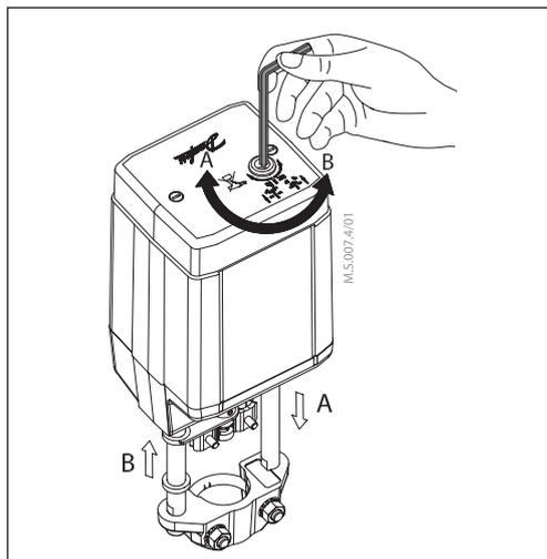
Die Handverstellung erfolgt durch Verstellen mit dem 4-mm-Innensechskantschlüssels (nicht im Lieferumfang enthalten) auf die gewünschte Position. Drehrichtungssymbol beachten.
