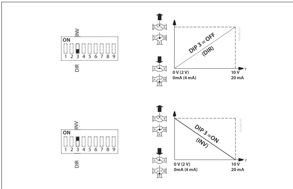
Unter der abnehmbaren Abdeckung des Stellantrieb befinden sich mehrere DIP-Schalter. Mit dem Schalter können folgende Funktionen ausgeführt werden:
