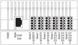
Abb. 4 Verdrahtungsschema – "CCR2+"-Führungsregler
