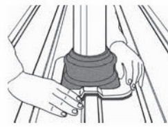
4. Dektite® formgenau an Profilblech anpassen
