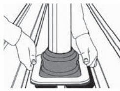
2. Dektite® an Profilblech anpassen und markieren
