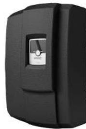
Die mitgelieferte Leistungsmesseinheit wird am Einspeisepunkt zum Netz vor dem Stromzähler installiert. Dadurch steuert die Regelung die Leistung der Elektroheizung entsprechend dem Überschuss aus der Photovoltaikanlage. Die schnelle Reaktionszeit von Leistungsmessung und Leistungsmodulation stellt sicher, dass kein Netzstrom für Heizzwecke verwendet wird.
