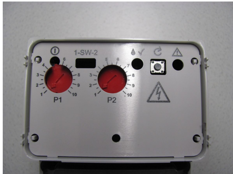
Abb. E-1: Potentiometer grob (P1) und fein (P2)
