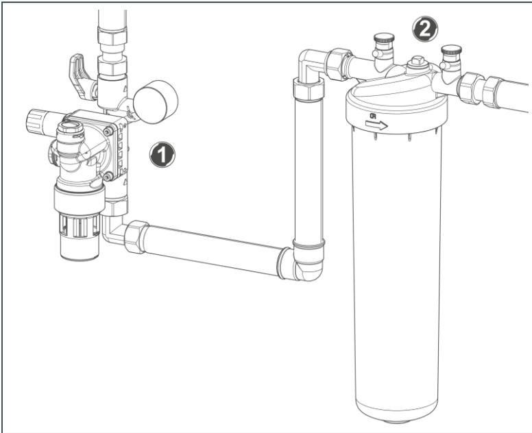
1. Montieren Sie die Füllgruppe in die vertikale Wasserleitung.
