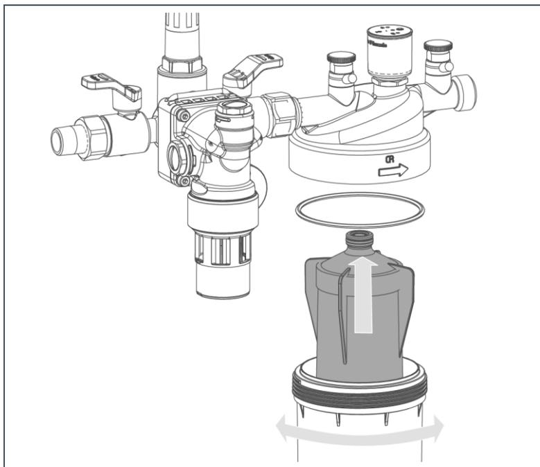
3. Demontieren Sie die Kunststoffglocke (Drehrichtung links).
