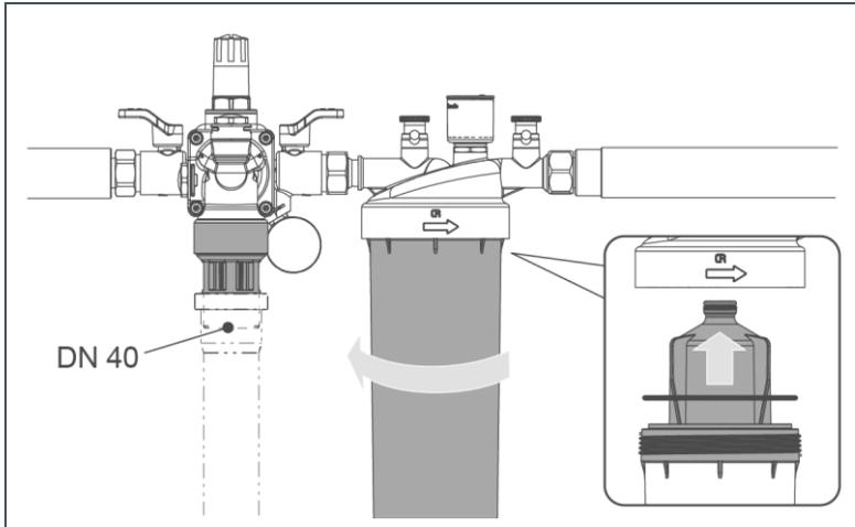
6. Montieren Sie einen Kanalanschluss DN 40 (nicht im Lieferumfang enthalten). Achten Sie auf freien Auslauf.
