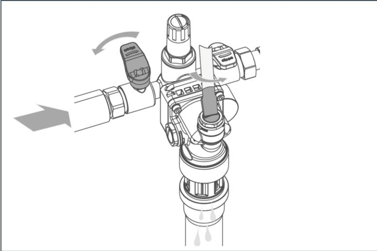
1. Öffnen Sie das Absperrventil am Eingang der Füllgruppe bis Wasserdruck anliegt und schließen Sie dieses anschließend wieder.
