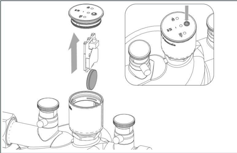
1. Ziehen Sie den Deckel der LF-Messzelle ab.
