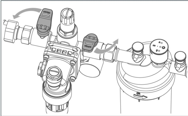
1. Öffnen Sie langsam das Absperrventil Trinkwasser (Eingang).
