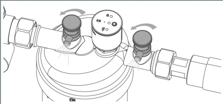
3. Öffnen Sie die Entlüftungsventile.
