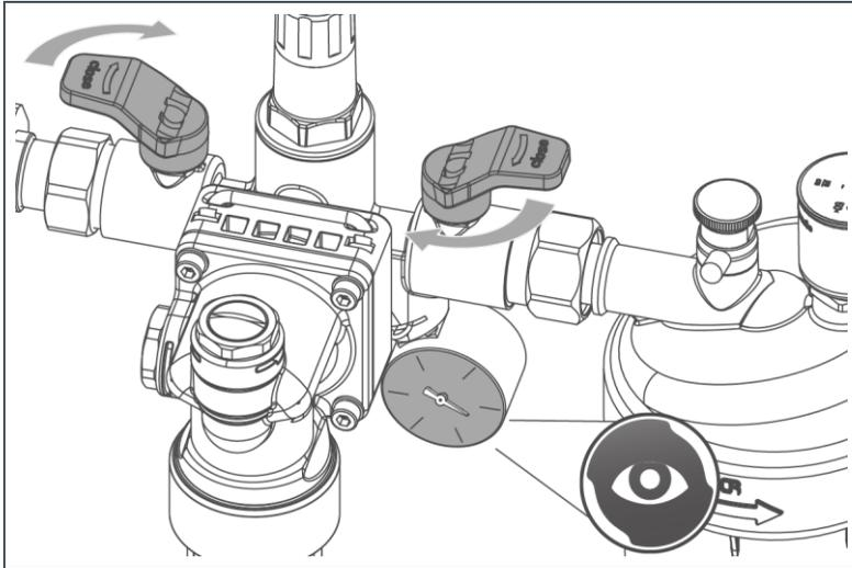
7. Schließen Sie nach dem Befüllen beide Absperrventile.
