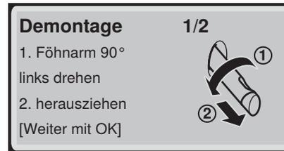
**15** Ziehen Sie die Föhndüse zur Reinigung ab und bestätigen Sie mit der Taste <OK>.
