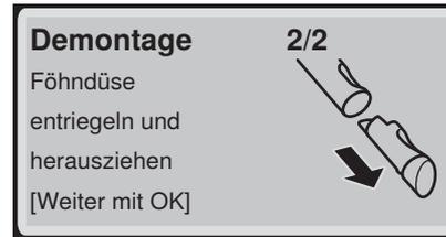
**16** Sprühen Sie den Föhnarm und die Föhndüse mit Geberit AquaClean Reinigungsmittel ein. Spülen Sie beide Teile anschliessend mit Wasser ab und bestätigen Sie mit der Taste <OK>.
