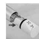
Druk op “Verkort spoelarm” om de spoelarm zonder sproeikop terug te bewegen. De opening voor de spoelarm kan met een vochtige doek worden gereinigd.
