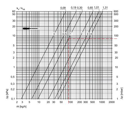
$Kv/Kvs = m^3/h$  bei einem Druckverlust von 1 bar.
