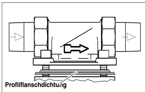
Abb. 5: Einbaudrehflansch
