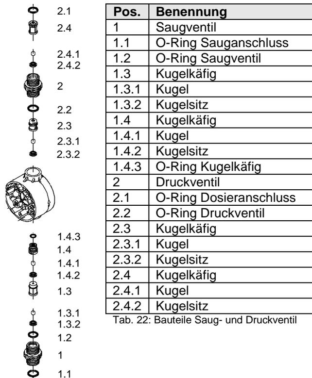
Tab. 22: Bauteile Saug- und Druckventil
