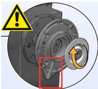
Abb. 16: Flansch und Dosiermembrane montieren
