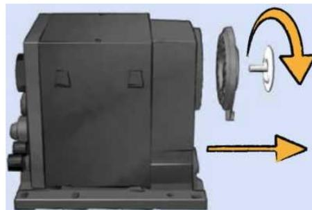
Abb. 15: Dosiermembrane demontieren
