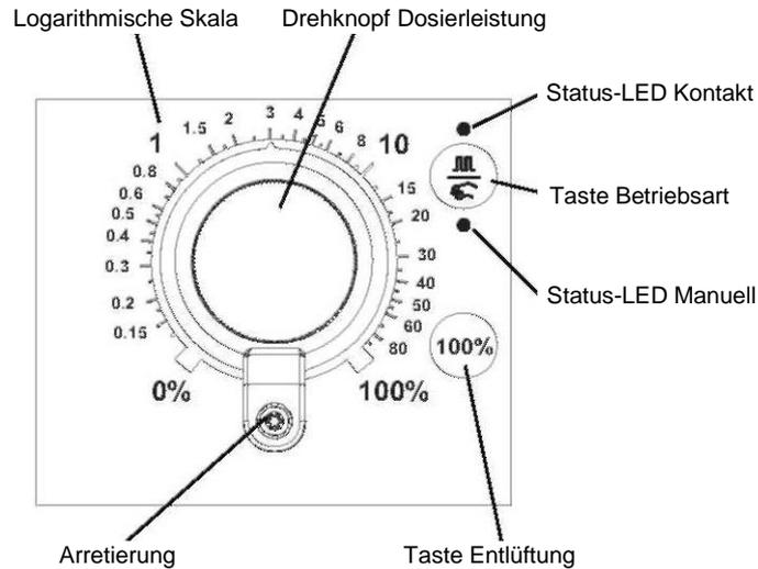
Abb. 11: Anzeige- und Bedienelemente
