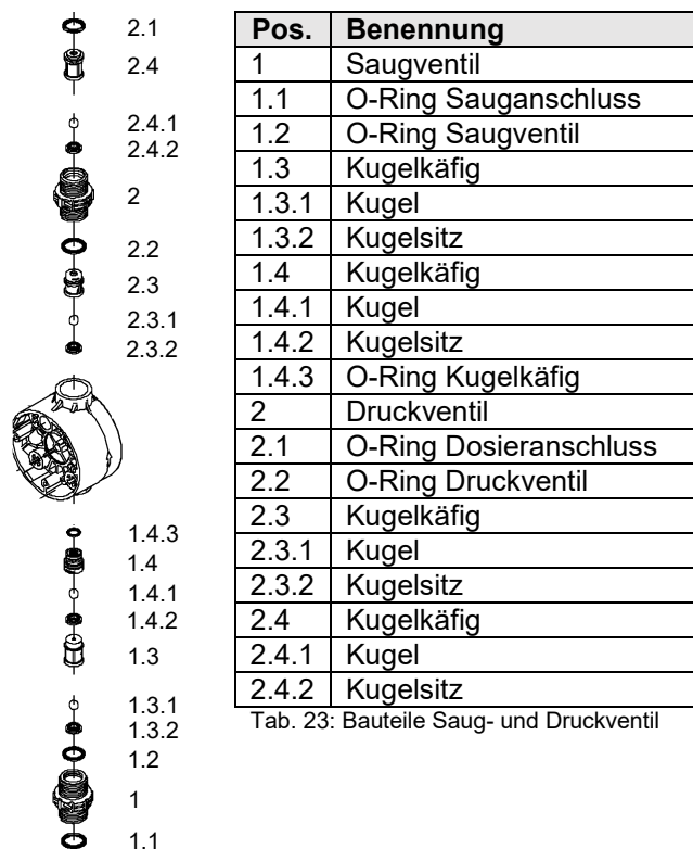
Abb. 24: Saug- und Druckventil
