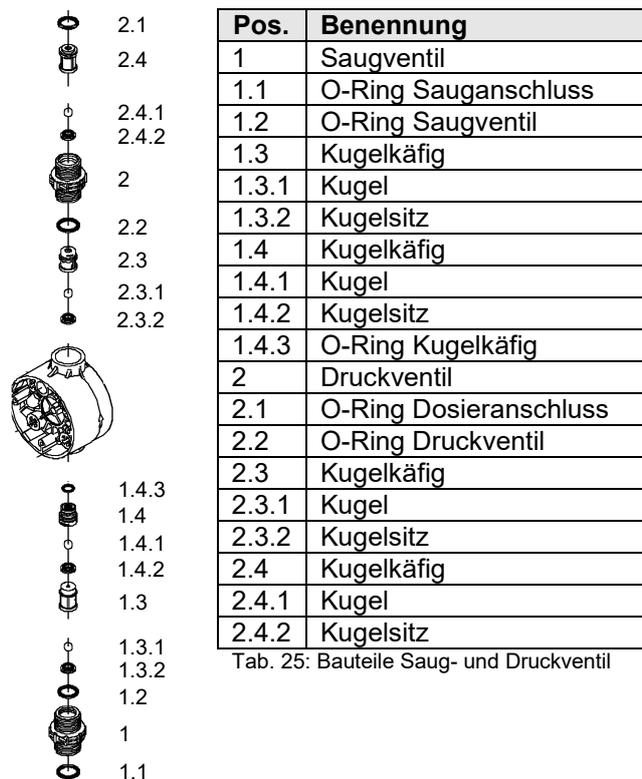
Tab. 25: Bauteile Saug- und Druckventil
