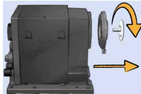
Abb. 14: Dosiermembrane demontieren
