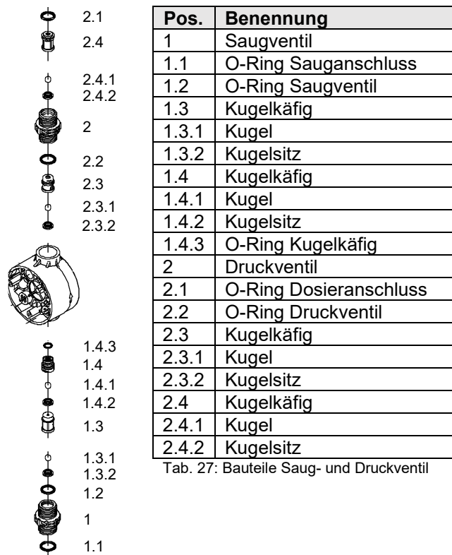
Abb. 23: Saug- und Druckventil
