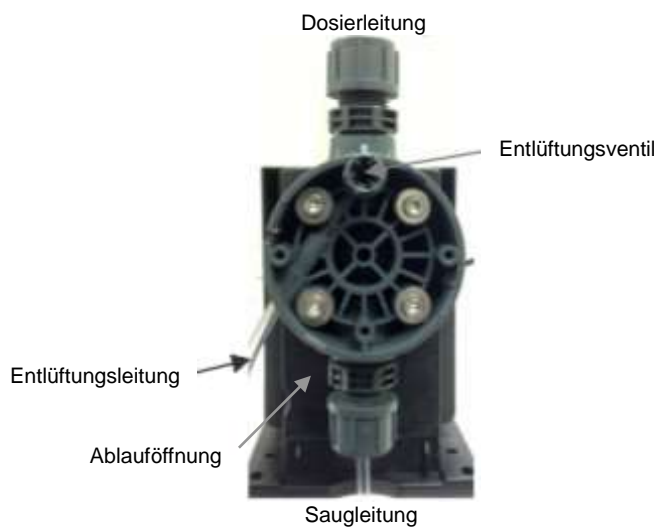
Abb. 6: Anschluss der Dosierpumpe
