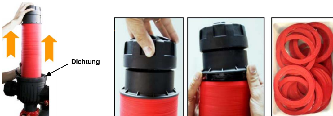
Abb. 12: Kunststoffdiscs reinigen und Dichtung kontrollieren
