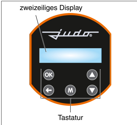
Abb. 11: Bedienfeld der Enthärtungsanlage
