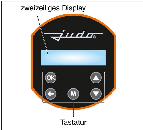
Abb. 11: Bedienfeld der Enthärtungsanlage
