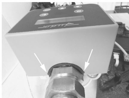
Abb. 10: Rückwand des Elektronikgehäuses einrasten
