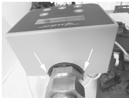
Afb. 10: Klik de achterwand van de elektronicabehuizing in
