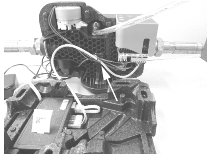
Afb. 8: Plaats de verbindingkabel in de kabelbinder
