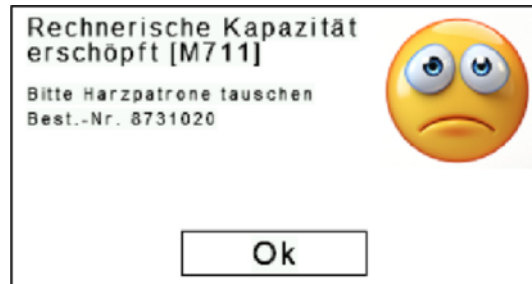
Abb. 23: Meldung: Rechnerische Kapazität erschöpft
