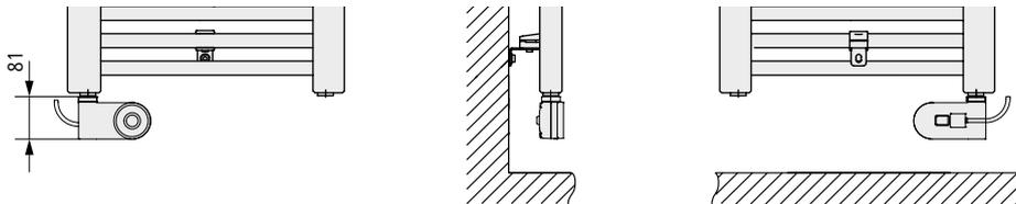
Abstand Unterkante Heizkörper zu Boden min. 150 mm.
