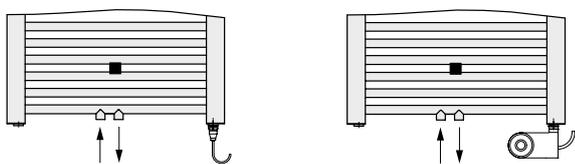
Anschluss des Heizungsvor- und -rücklaufs durch Mittenanschluss 50 mm: Installation eines Elektro-Heizstabes im linken oder rechten Sammelrohr ohne Einschränkung möglich.
