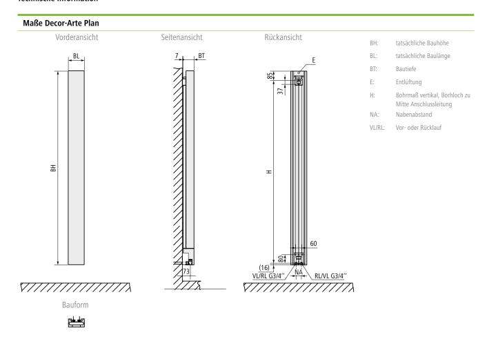
Abstand Unterkante Heizkörper zu Boden min. 150 mm. Nach optischen Gesichtspunkten sollte die Heizkörperposition der individuellen Raumsituation angepasst werden.
