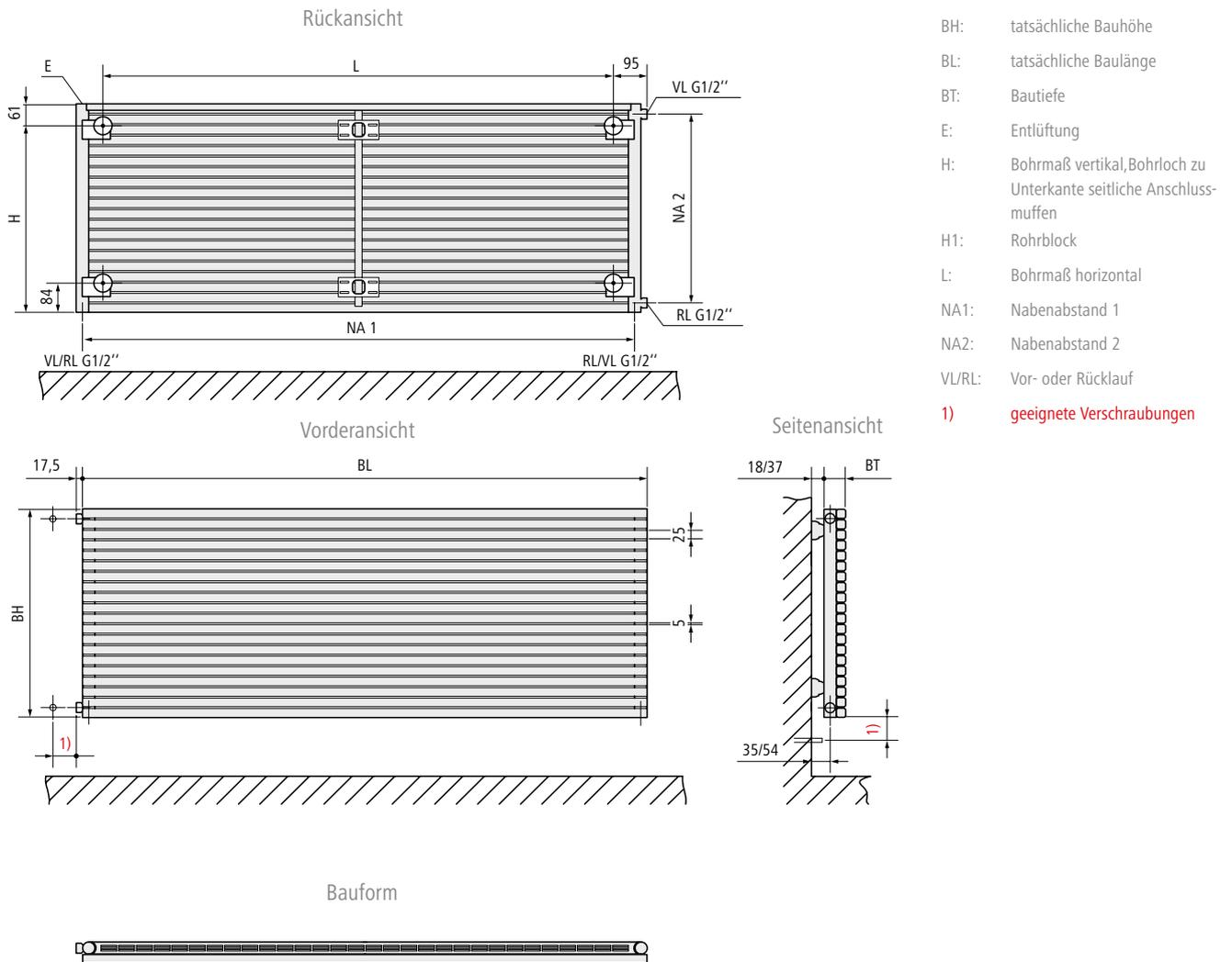
Abstand Unterkante Heizkörper zu Boden min. 150 mm.
