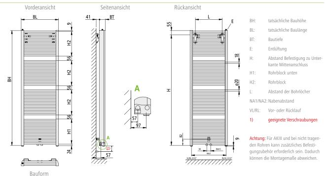
Abstand Unterkante Heizkörper zu Boden min. 150 mm.
